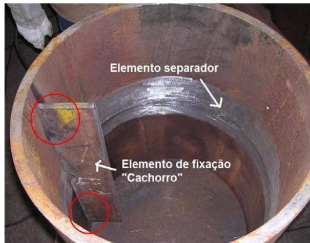
Figura 20. Posicionamento e pontos de soldagem para o elemento de fixação.
