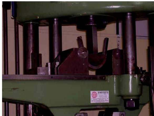
Figura 28. Ensaio de dobramento lateral.
