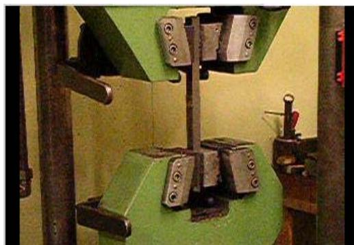
Figura 27. Posicionamento do corpo-de-prova no ensaio de Tração.
