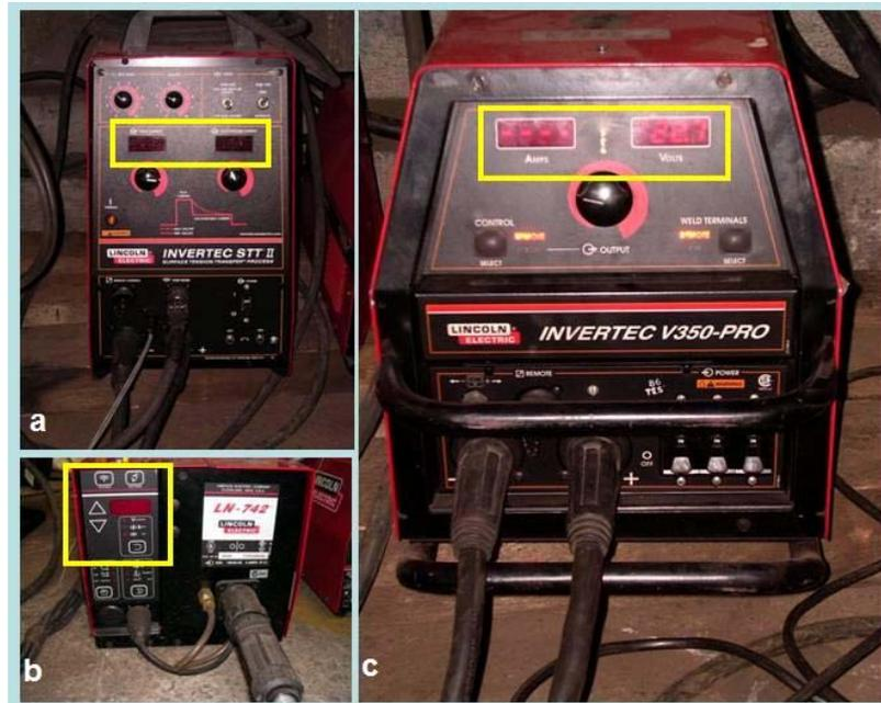
Figura 23. Painéis de controle de amperagem e voltagem marcados em retângulos amarelos, a) Máquina de soldagem Invertec STT II, amperagem de pico e de base b) Alimentador de arame LN-742, voltagem para o processo STT e c) Máquina de soldagem Invertec V350- Pro, amperagem e voltagem.
