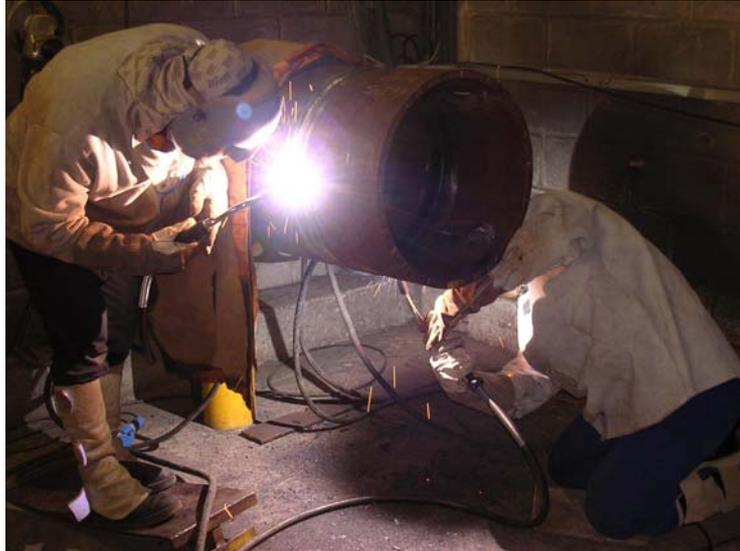
Figura 21. Tubo na posição horizontal fixo.
