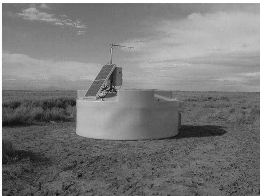
Figura 4.2: Foto de um detector de água Cherenkov no campo.
