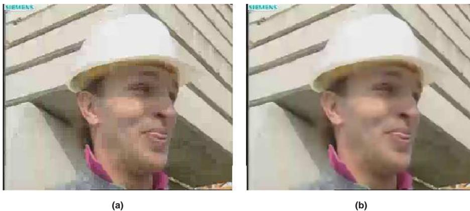
Figura 3.7: (a) Sem filtro *deblocking* (b) Com filtro *deblocking*
