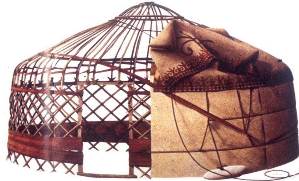
Figura 43: Ilustração de um Yurt (habitação típica das estepes) mostrando a sua estrutura (ilustração: Allan Sutie / LA MADERA)
