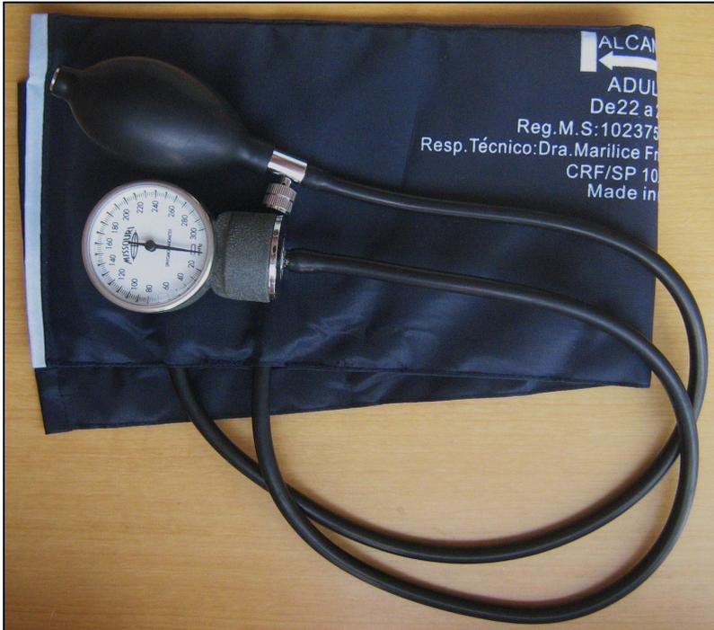
Figura 3 - Modelo atual do esfigmomanômetro mecânico aneróide.
