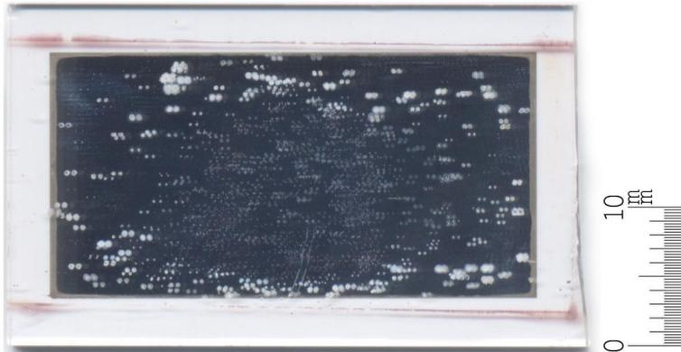
Figura 44. Catodo de amostra de vidro boro-silicato após o tratamento eletro-térmico, mostrando alterações no aspecto da superfície do vidro.
