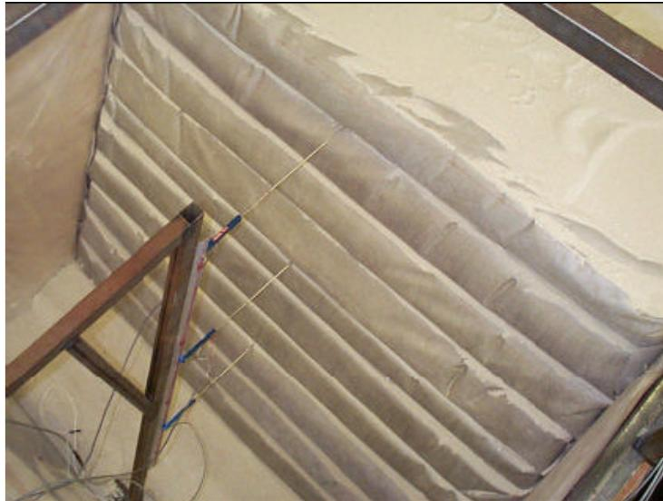
Figura 2.16 - Sistema de instrumentação com acelerômetros, potenciômetros e condição da face do modelo construído por Perez (1999).
