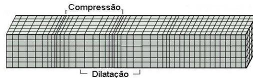
Figura 2.5 – Deformações produzidas por ondas P (apud Kramer, 1996).
