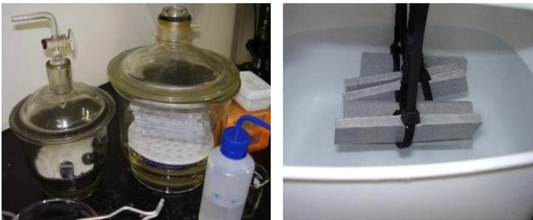
Figura 25 – Corpos imersos em água destilada no processo de degradação por absorção
