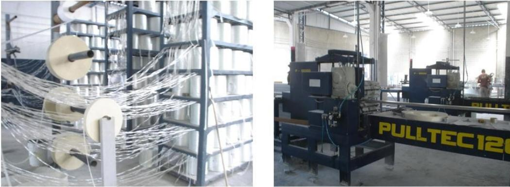
Figura 11 – Processo de produção do compósito pultrudado
