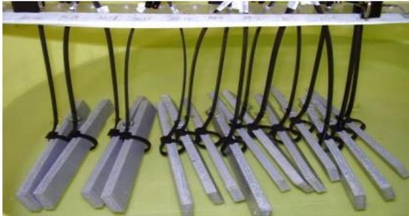
Figura 26 – Corpos imersos em água destilada no processo de degradação por absorção para o ensaio mecânico de flexão em três pontos
