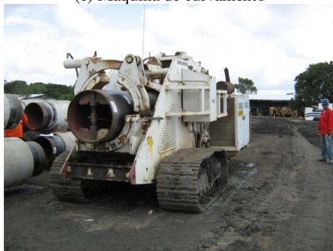
(e) Máquina com tubo com imobilizador
