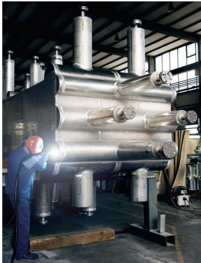
Figura 25 Vista do Trocador de Calor de Placa Aletada (PFHE) (Martin, 2004)
