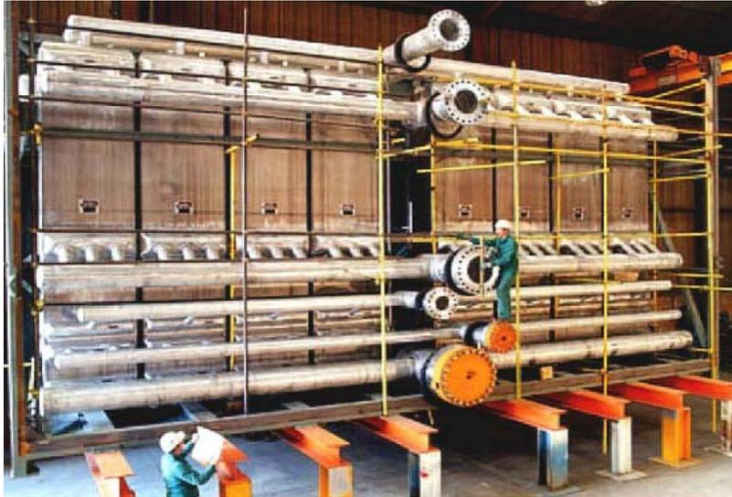
Figura 24 (PFHE) Vista geral do trocador de Calor de Placa Aletada (PFHE) (Martin, 2004)
