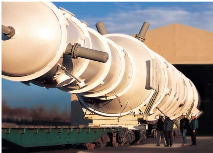
Figura 22 (SWHE) Trocador de Calor de Espiral Enrolada (Kessler, 2007)
