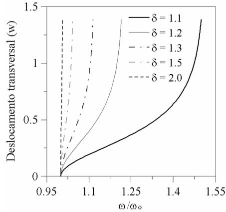
Figura 6.36 - Relação normalizada frequência – deslocamento transversal ( $m$ ) da membrana anular ( $\kappa = 0.5$ ;  $\rho_0 = 0.20 m$ ).
