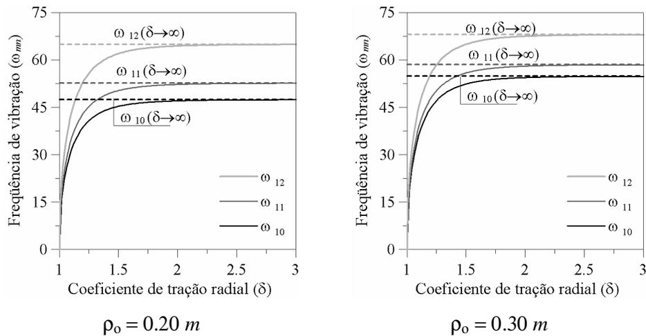
Figura 6.6 – Variação da frequência de vibração (rad/s) em função do coeficiente de tração radial da membrana anular.
