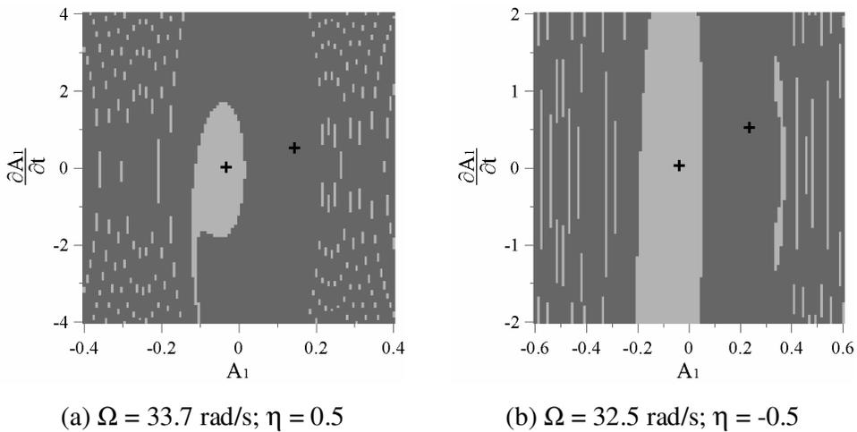
Figura 6.55 – Bacia de atração no plano fase das condições iniciais  $A_{10} \times \dot{A}_{10}$
