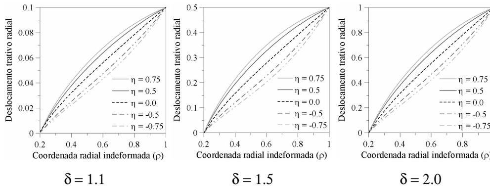
Figura 6.39 – Variação do deslocamento radial ( $m$ ) da membrana anular com espessura variável para diferentes valores de  $\eta$  ( $\rho_o = 0.20 m$ ).
