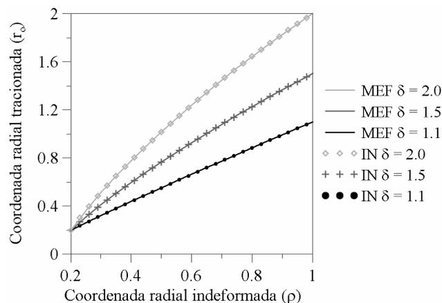
Figura 6.38 – Variação do comprimento radial tracionado da membrana anular com espessura variável ( $\eta = 0.5$ ;  $\rho_o = 0.20 \text{ m}$ ).
