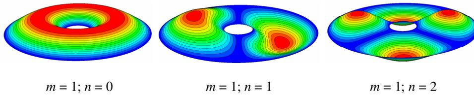
Figura 6.9 – Modos de vibração da membrana anular ( $\rho_o = 0.20 m$ ).
