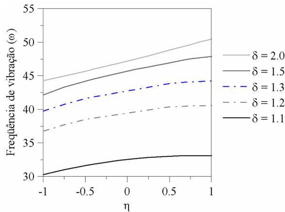
Figura 6.42 - Frequência de vibração (rad/s) em função do coeficiente de variação da espessura  $\eta$  para diferentes valores de  $\delta$  ( $\rho_o = 0.20 m$ ).
