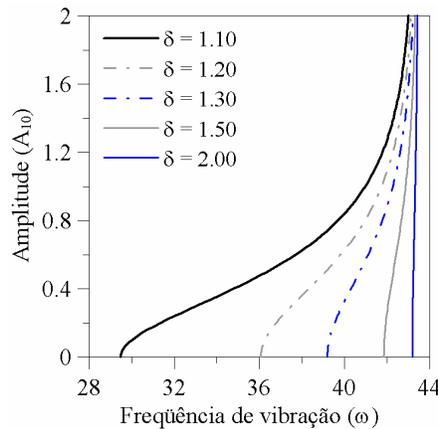
Figura 6.35 - Relação frequência (rad/s) – amplitude ( $m$ ) para vibração livre da membrana anular com diferentes valores de  $\delta$  ( $\kappa = 0.5$ ;  $\rho_0 = 0.20 m$ )
