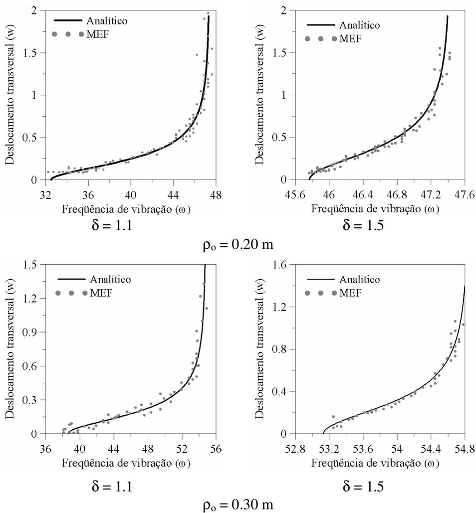
Figura 6.14 - Relação frequência de vibração (rad/s) - deslocamento transversal ( $m$ ).
