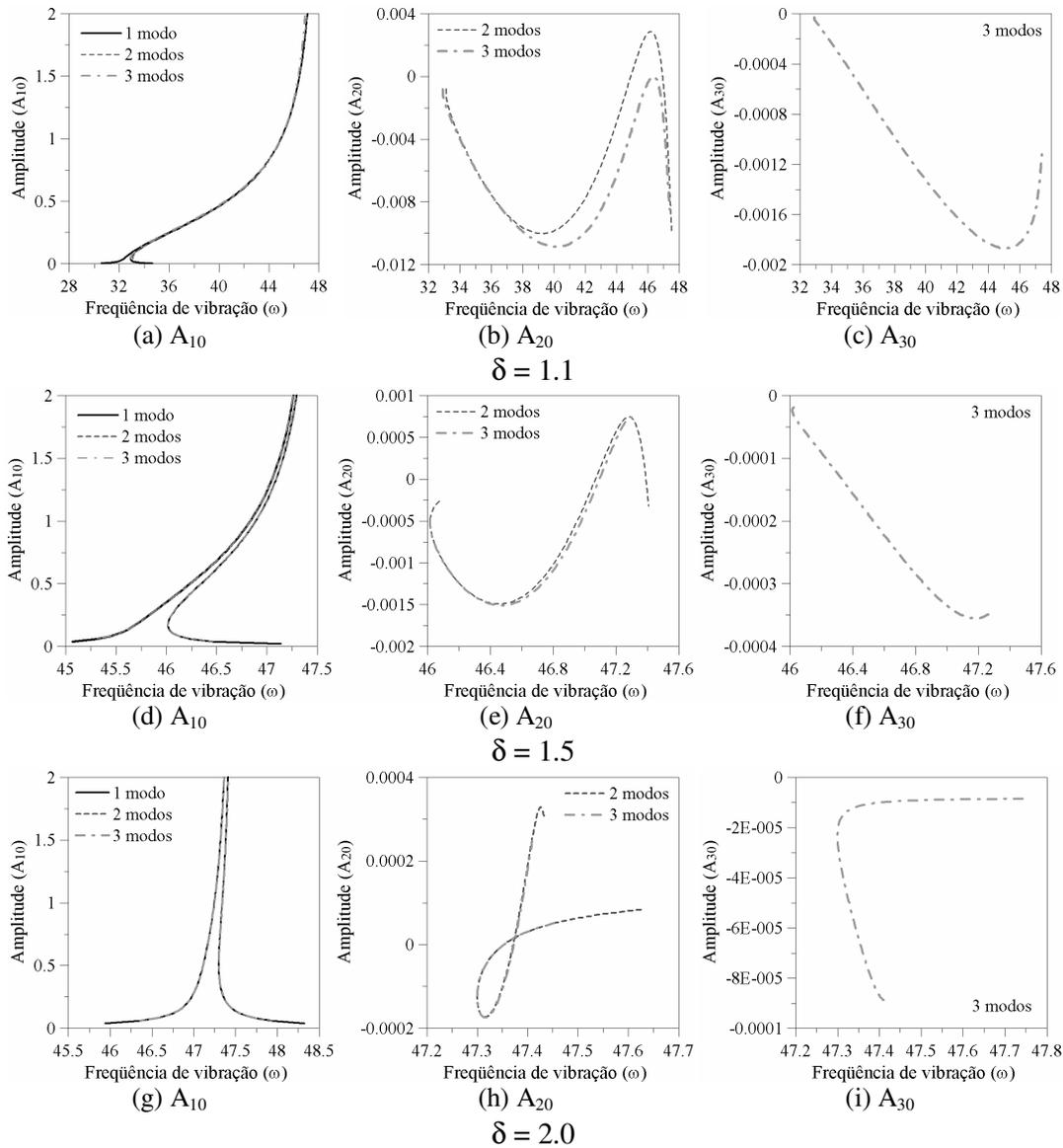
Figura 6.21 – Curva de ressonância não linear da membrana anular ( $\rho_0 = 0.20 m$ ).
