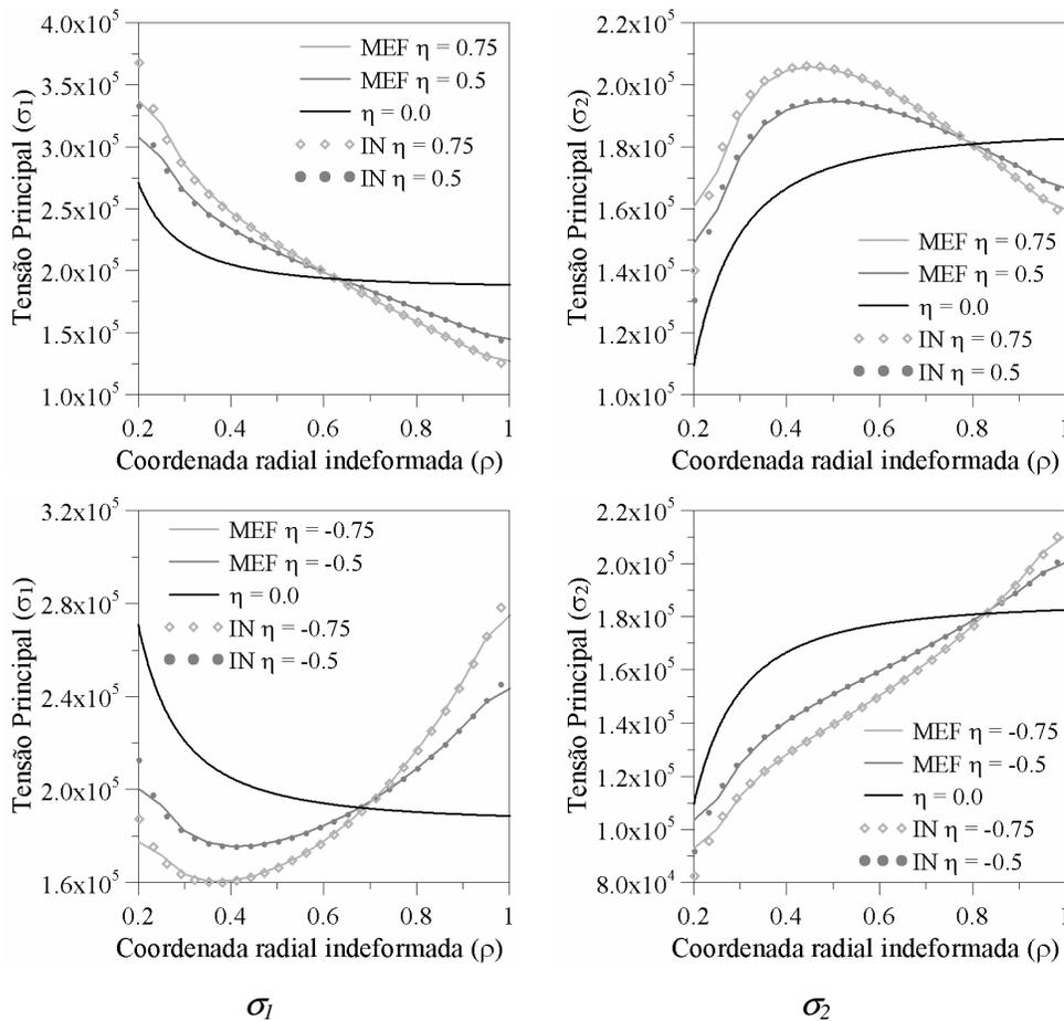
Figura 6.40 – Tensões principais ( $N/m^2$ ) da membrana anular tracionada com espessura variável para diferentes valores de  $\eta$ . ( $\delta = 1.10$ ;  $\rho_o = 0.20 m$ ).
