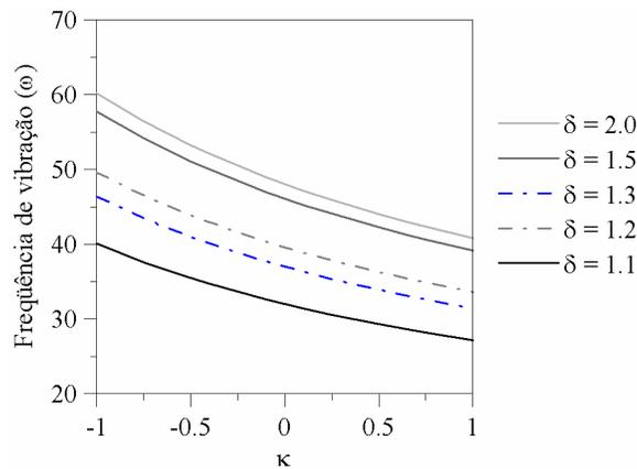
Figura 6.32 - Frequência de vibração (rad/s)-coeficiente de variação da massa específica ( $\rho_o = 0.20 m$ ).
