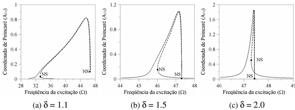
Figura 6.24 – Diagramas de bifurcação. Coordenada de Poincaré  $A_{10}$  ( $m$ ) como função da frequência de excitação  $\Omega$  (rad/s) ( $P_o = 1 \text{ N/m}^2$ ;  $\zeta = 0.05$ ;  $\rho_o = 0.20 \text{ m}$ ).
