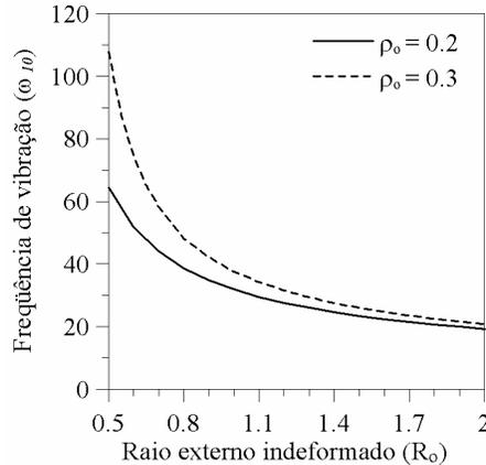
Figura 6.8 - Variação de frequência de vibração (rad/s) em função do raio indeformado,  $R_o$  (m).
