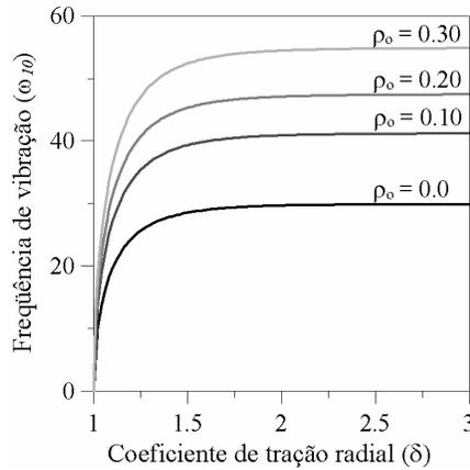
Figura 6.7 – Variação da frequência de vibração (rad/s) em função do coeficiente de tração radial para diferentes valores do raio interno da membrana anular.
