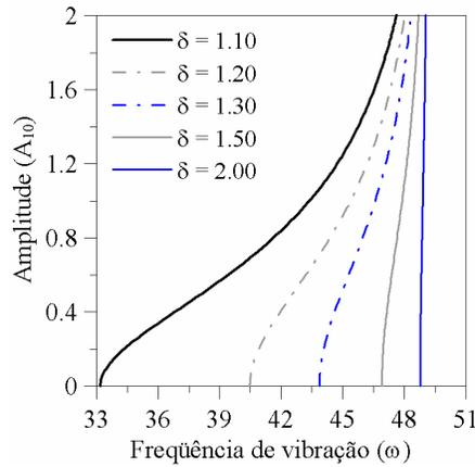
Figura 6.44 - Relação frequência (rad/s) - amplitude ( $m$ ) para vibração livre da membrana anular com diferentes valores de  $\delta$  ( $\eta = 0.5$ ;  $\rho_o = 0.20 m$ ).
