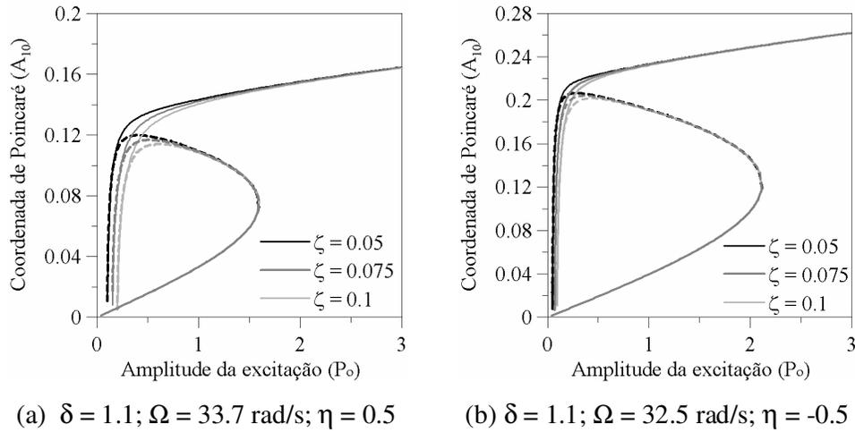
Figura 6.53 – Diagramas de bifurcação com diferentes valores de amortecimento. Coordenada de Poincaré  $A_{10}$  (m) como função da amplitude da excitação  $P_0$  ( $N/m^2$ ) ( $\rho_0 = 0.20 \text{ m}$ ).
