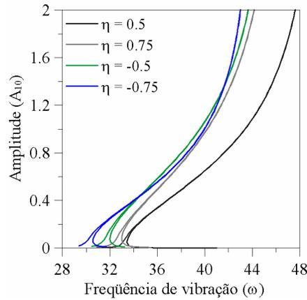
Figura 6.49 - Relação frequência (rad/s) – amplitude ( $m$ ) para vibração forçada da membrana anular com diferentes valores de  $\eta$  ( $\delta = 1.1$ ;  $\rho_o = 0.20 m$ ).
