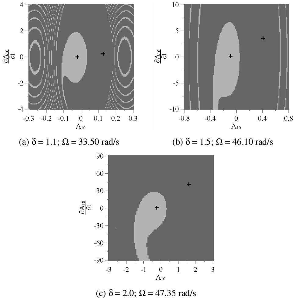
Figura 6.29 – Bacia de atração no plano fase das condições iniciais  $A_{10} \times \dot{A}_{10}$  ( $P_o = 1 \text{ N/m}^2; \zeta = 0.05; \rho_o = 0.20 \text{ m}$ ).
