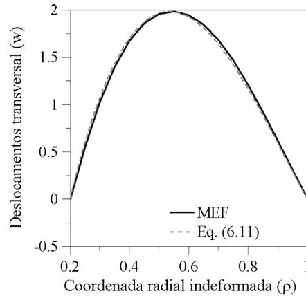
Figura 6.3 – Deslocamento transversal ( $m$ ) da membrana anular pré-tensionada em vibração livre em um certo tempo  $t$  ( $\delta = 1.1, \rho_o = 0.2 m$ ).
