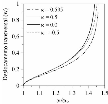
Figura 6.34 - Relação normalizada frequência – deslocamento transversal ( $w$ ) da membrana anular ( $\delta = 1.10$ ;  $\rho_0 = 0.20 m$ ).
