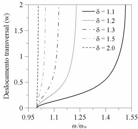
Figura 6.45 - Relação normalizada frequência – deslocamento transversal ( $m$ ) da membrana anular ( $\eta = 0.5$ ;  $\rho_o = 0.20 m$ ).
