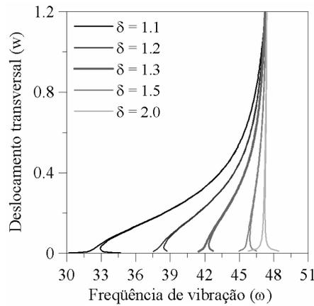
Figura 6.22 – Relação frequência (rad/s) - deslocamento transversal ( $m$ ) para a vibração forçada da membrana anular com diferentes  $\delta$  ( $\rho_o = 0.20 m$ ).
