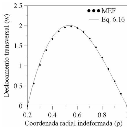
Figura 6.15 - Deslocamento transversal ( $w$ ) da membrana anular em vibração livre, em um tempo  $t$  ( $\delta = 1.1$ ;  $\rho_0 = 0.20$  m).
