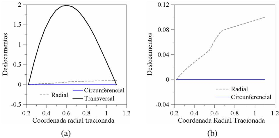
Figura 6.10 – (a) Variação dos deslocamentos ( $m$ ) da membrana circular pré-tensionada sob grande amplitude de vibração ao longo do raio tracionado. (b) Detalhe dos deslocamentos radial e circunferencial ( $\delta = 1.1, \rho_o = 0.2 m$ ).
