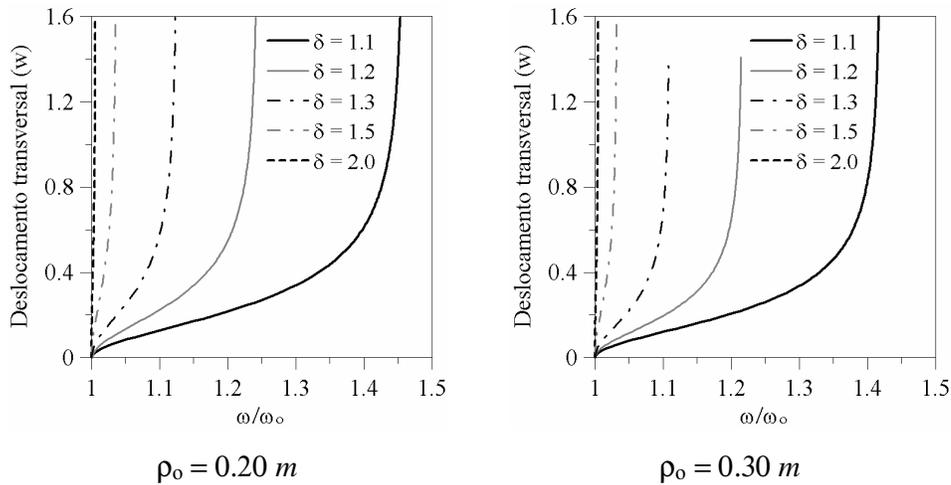
Figura 6.16 - Relação normalizada frequência – deslocamento transversal ( $m$ ) da membrana anular.
