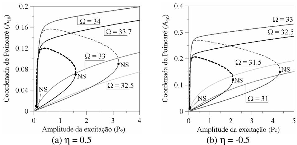
Figura 6.54 - Diagramas de bifurcação com diferentes valores da frequência de excitação. Coordenada de Poincaré  $A_{10}$  (m) em função da amplitude da excitação  $P_0$ . ( $N/m^2$ ) ( $\delta = 1.1; \zeta = 0.05; \rho_0 = 0.20 \text{ m}$ )
