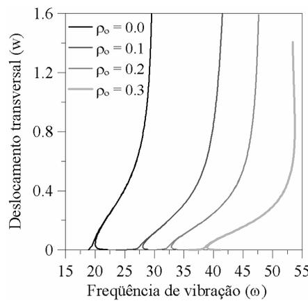
Figura 6.23 – Relação frequência (rad/s) - deslocamento transversal ( $m$ ) para a vibração forçada da membrana anular com diferentes  $\delta$ .
