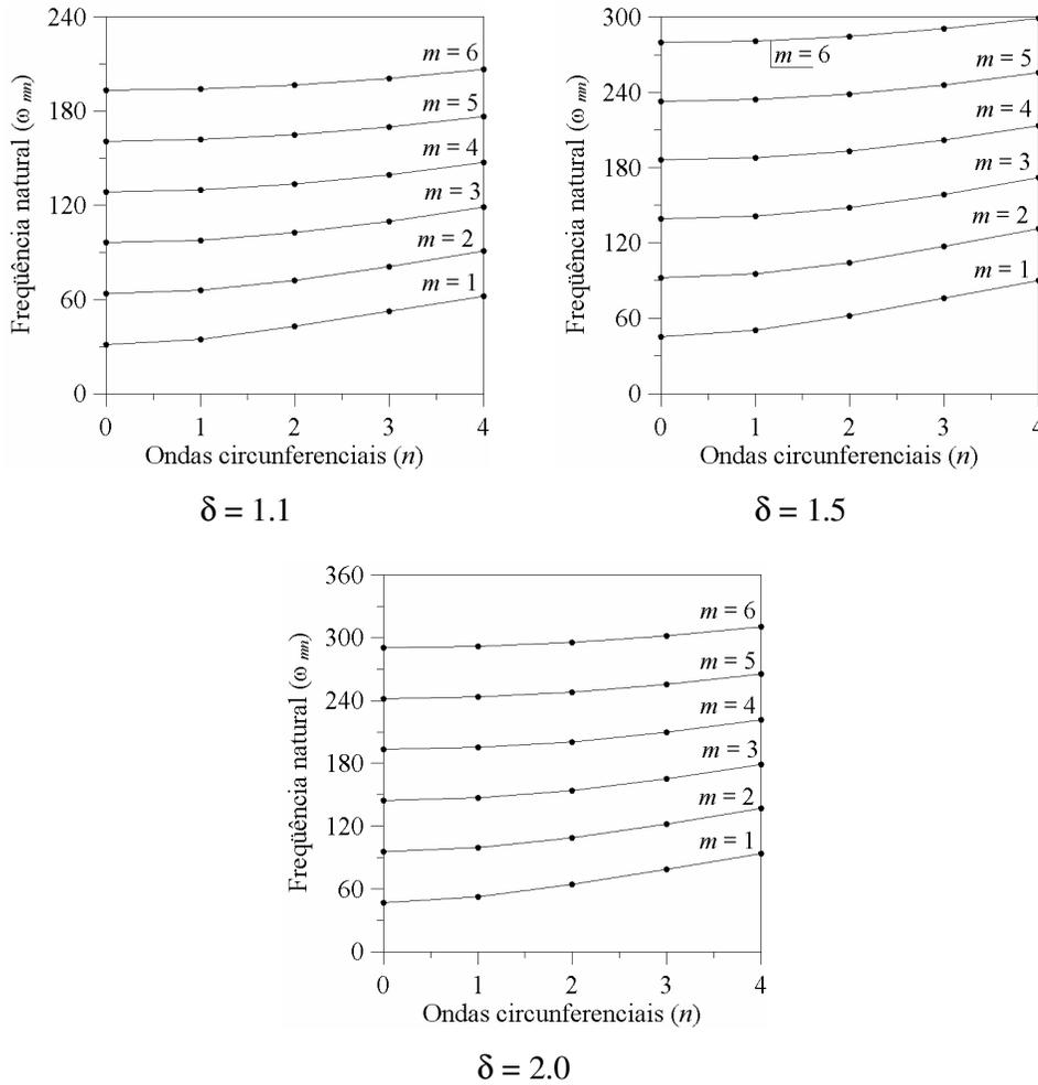
Figura 6.5 - Espectro das frequências naturais (rad/s) da membrana anular. Frequência natural em função de  $n$  ( $\rho_o = 0.20 m$ ).
