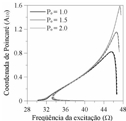
Figura 6.25 – Curvas de ressonância. Amplitude de vibração  $A_{10}$  ( $m$ ) como função da frequência de excitação  $\Omega$  (rad/s) ( $\zeta = 0.05$ ;  $\delta = 1.1$ ;  $\rho_o = 0.20 \text{ m}$ ).
