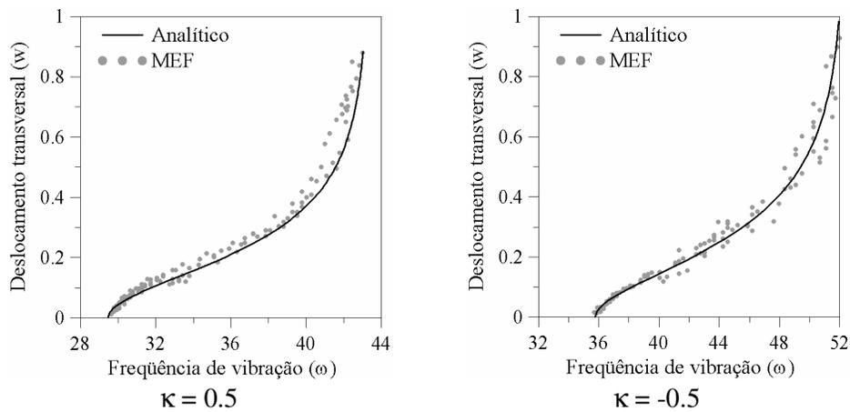
Figura 6.37 - Relação frequência de vibração (rad/s) - deslocamento transversal ( $m$ ) ( $\delta = 1.10$ ;  $\rho_0 = 0.20 m$ )
