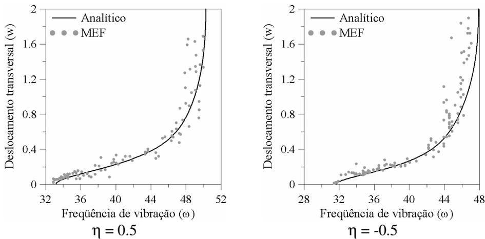
Figura 6.47 - Relação frequência de vibração (rad/s) - deslocamento transversal ( $m$ ) ( $\delta = 1.1$ ;  $\rho_o = 0.20 m$ ).
