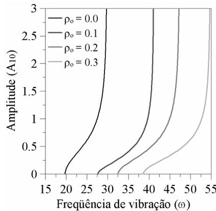
Figura 6.13 - Relação frequência (rad/s) – amplitude ( $m$ ) para vibração livre da membrana anular com diferentes valores de  $\rho_0$ .
