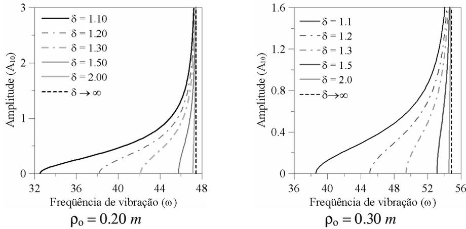
Figura 6.12 - Relação frequência (rad/s) - amplitude ( $m$ ) para vibração livre da membrana anular com diferentes valores de  $\delta$ .
