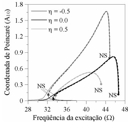
Figura 6.51 – Diagrama de bifurcação. Coordenada de Poincaré  $A_{10}$  (m) como função da frequência de excitação  $\Omega$  (rad/s) ( $P_o = 1 \text{ N/m}^2$ ;  $\zeta = 0.05$ ;  $\delta = 1.1$ ;  $\rho_o = 0.20 \text{ m}$ ).
