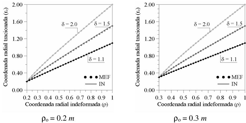
Figura 6.1 – Variação do comprimento radial tracionado da membrana anular.
