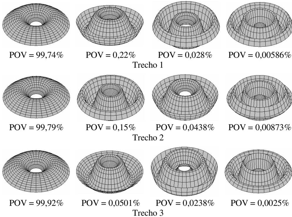
Figura 6.19 - Quatro primeiros POMs e seus respectivos POVs para a vibração livre não linear da membrana anular ( $\delta = 1.1$ ;  $\rho_0 = 0.2 m$ ).
