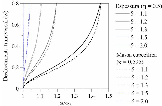
Figura 6.48 - Relação normalizada frequência – deslocamento transversal ( $m$ ) da membrana anular com variação de espessura e massa específica ( $\rho_0 = 0.20 m$ ).
