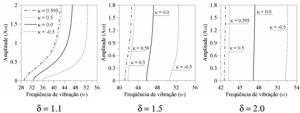
Figura 6.33 - Relação frequência (rad/s) - amplitude ( $m$ ) para vibração livre da membrana anular com diferentes valores de  $\kappa$  ( $\rho_o = 0.20 m$ ).
