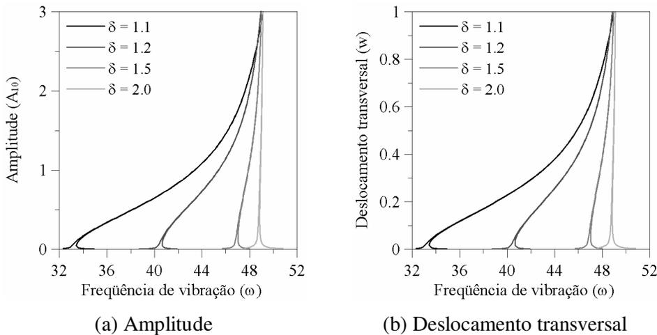
Figura 6.50 – Curva de ressonância para a vibração forçada da membrana anular com espessura variável com diferentes  $\delta$ . ( $\eta = 0.5$ ;  $\rho_o = 0.20 m$ )
