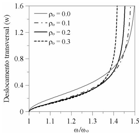
Figura 6.17 - Relação normalizada frequência-deslocamento transversal ( $m$ ) da membrana anular com diferentes valores do raio interno. ( $\delta = 1.1$ )
