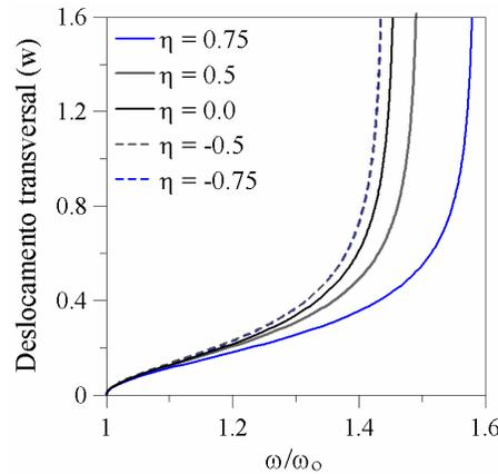
Figura 6.46 - Relação normalizada frequência-deslocamento transversal ( $m$ ) da membrana circular ( $\delta = 1.1$ ;  $\rho_o = 0.20 m$ ).
