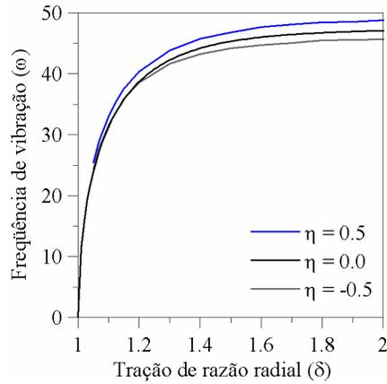
Figura 6.41 - Frequência de vibração (rad/s) - razão de tração radial para diferentes variações da espessura da membrana anular ( $\rho_o = 0.20 m$ ).
