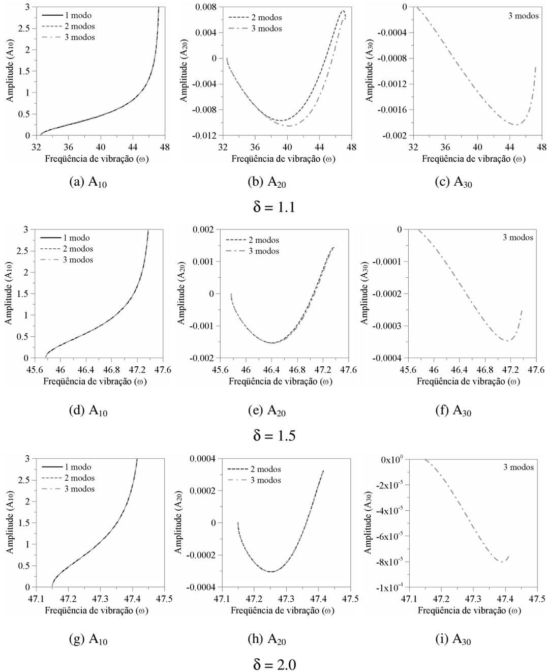
Figura 6.11 – Variação da frequência de vibração (rad/s) com a amplitude modal ( $m$ ), considerando-se um número crescente de modos em (6.16) ( $\rho_0 = 0.20 m$ ).
