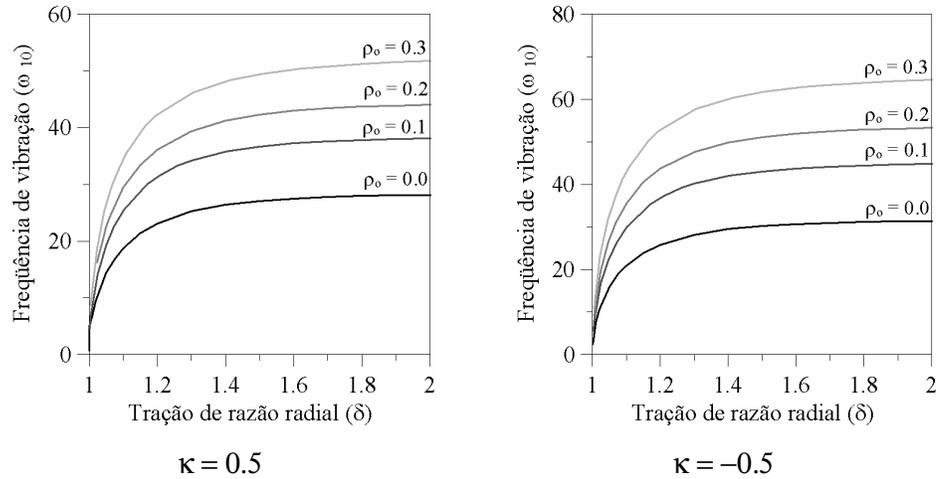
Figura 6.31 - Frequência de vibração ( $\omega_{10}$ ) em função do coeficiente de tração radial para diferentes valores do raio interno.
