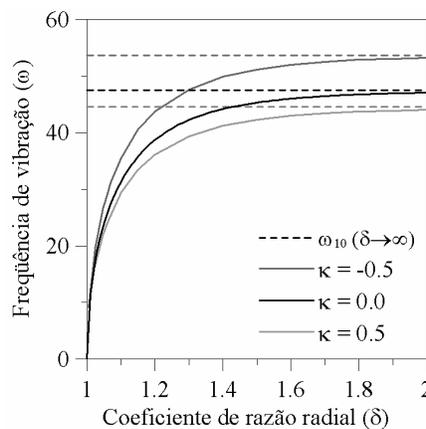
Figura 6.30 - Frequência de vibração ( $\omega_{10}$ ) em função do coeficiente de tração radial para diferentes variações da massa específica ( $\rho_0 = 0.20 m$ ).
