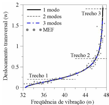
Figura 6.18 – Trechos da curva frequência (rad/s) – deslocamento transversal ( $m$ ) da membrana em vibração livre para decomposição de Karhunen-Loève ( $\delta = 1.1$ ;  $\rho_0 = 0.20 m$ ).
