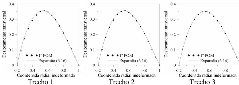
Figura 6.20 – Comparação da deformada obtida a partir da expansão (6.16) com o primeiro POM da expansão de Karhunen-Loève ( $\delta = 1.1$ ;  $\rho_0 = 0.2 m$ ).
