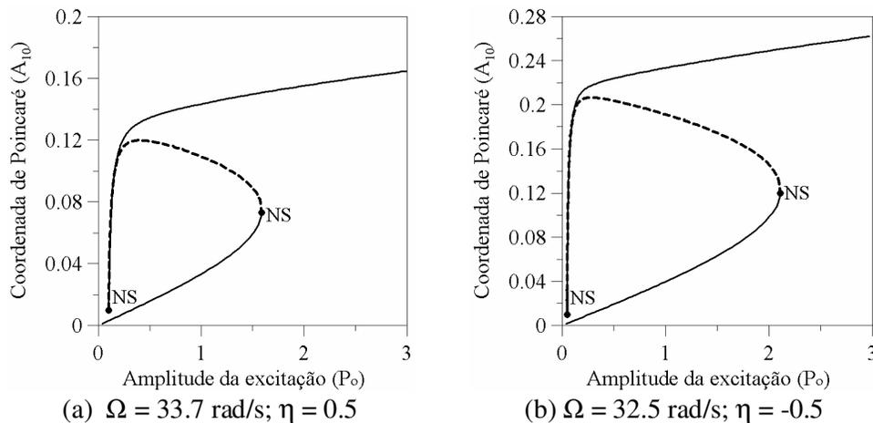
Figura 6.52 – Diagramas de bifurcação para valores selecionados da frequência de excitação. Coordenada de Poincaré  $A_{10}$  (m) como função da amplitude da excitação  $P_o$  ( $\text{N/m}^2$ ) ( $\zeta = 0.05$ ;  $\delta = 1.1$ ;  $\rho_o = 0.20 \text{ m}$ ).
