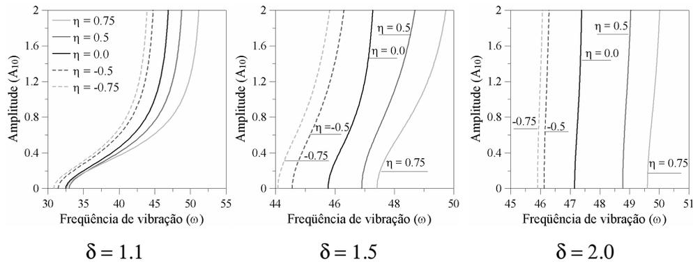
Figura 6.43 - Relação frequência (rad/s) – amplitude ( $m$ ) para vibração livre da membrana anular com diferentes valores de  $\eta$  ( $\rho_0 = 0.20\ m$ ).
