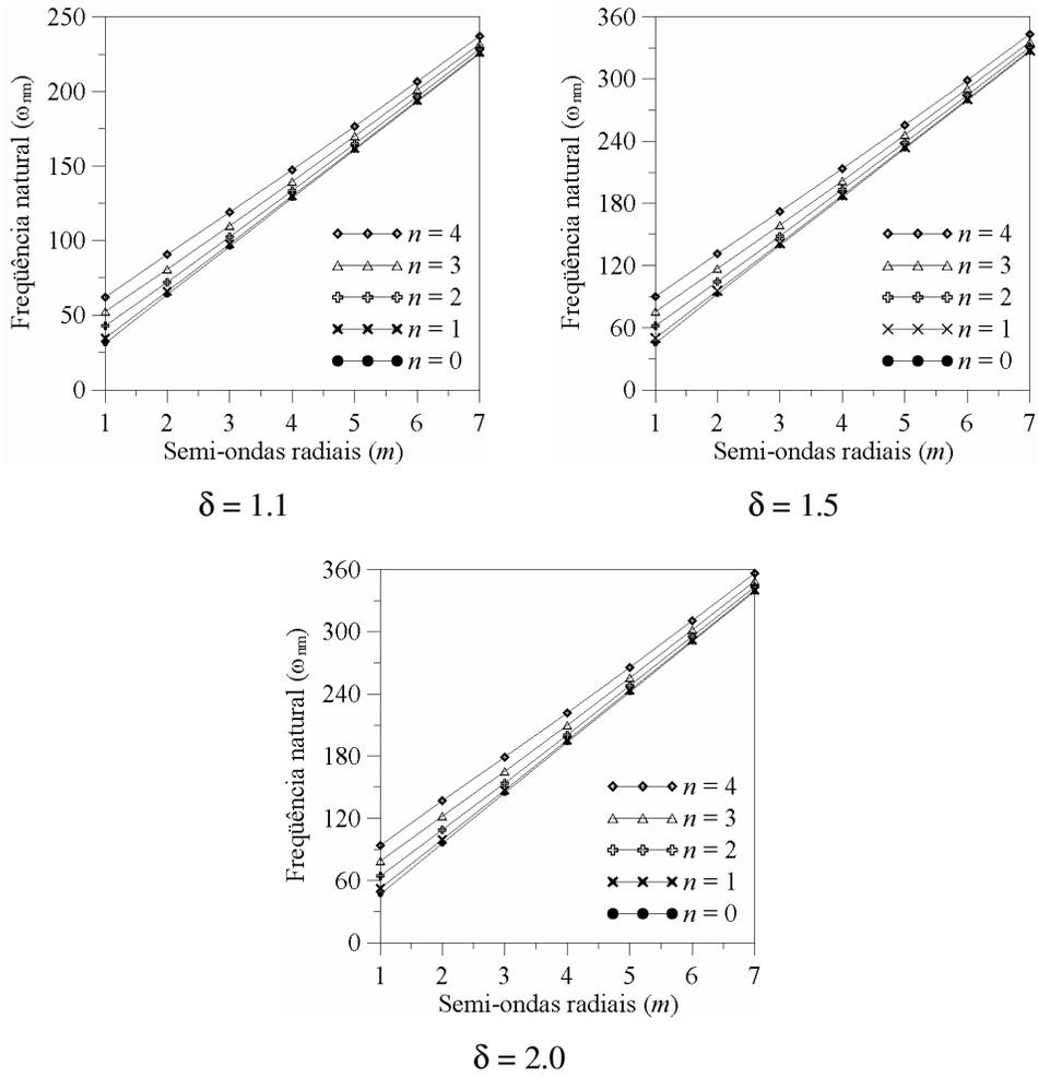
Figura 6.4 - Espectro das frequências naturais (rad/s) da membrana anular. Frequência natural em função de  $m$  ( $\rho_o = 0.20 m$ ).
