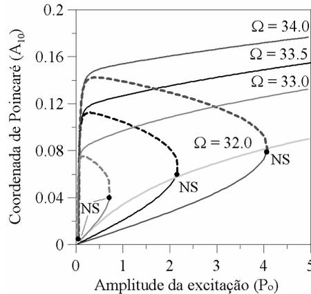
Figura 6.28 - Diagramas de bifurcação com diferentes valores da frequência de excitação  $\Omega$ . Coordenada de Poincaré  $A_{10}$  (m) em função da amplitude da excitação  $P_o$  ( $N/m^2$ ) ( $\delta = 1.1$ ;  $\zeta = 0.05$ ;  $\rho_o = 0.20 m$ )
