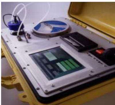
Figura 16 – Analisador portátil de gases dissolvidos no OMI
