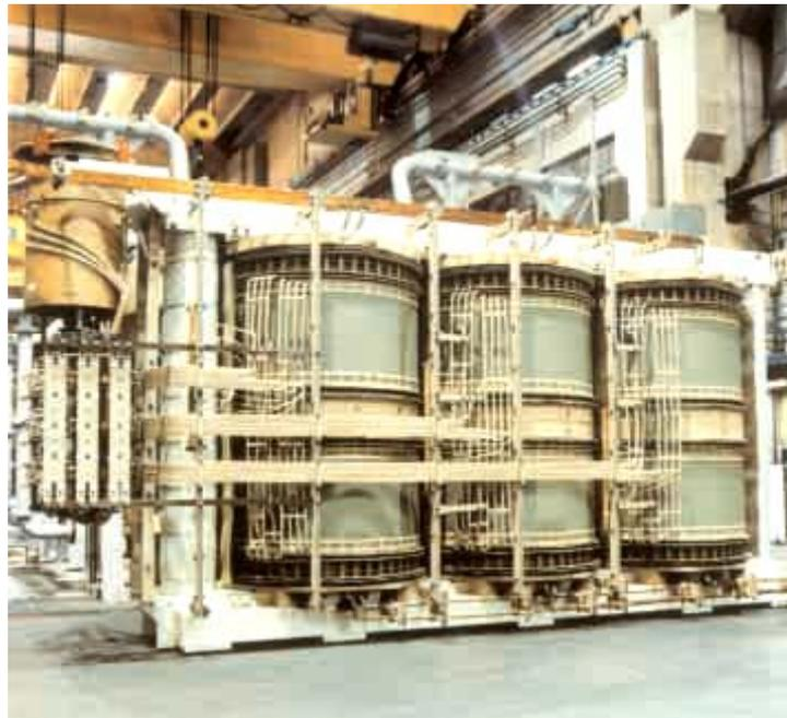
Figura 7 – Parte ativa completa: Núcleo e enrolamentos
