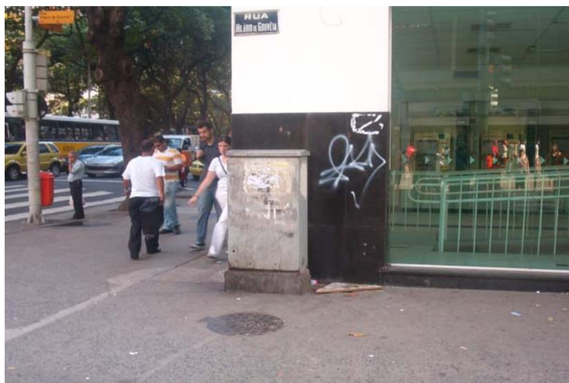
Figura 34: Armário fibra ótica instalado na Rua Hilário de Gouvêa
