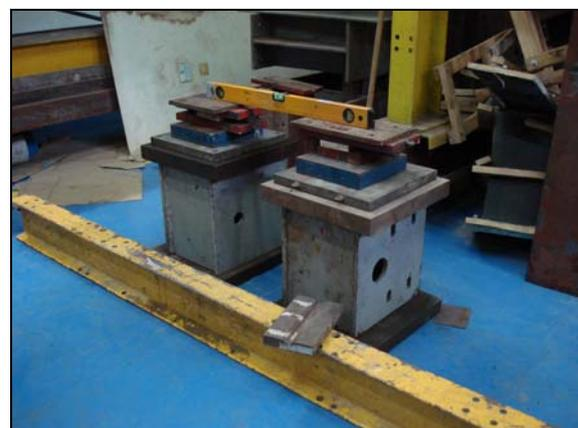
Figura 4.5 – Sistema de apoios: móvel e fixo.
