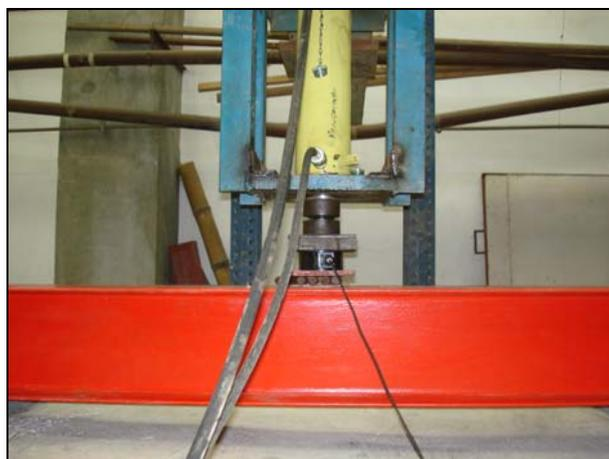
Figura 4.16 – Célula de carga.
