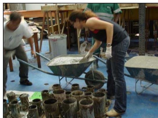
Figura 4.10 – Concretagem da laje, LEM – PUC-Rio.
