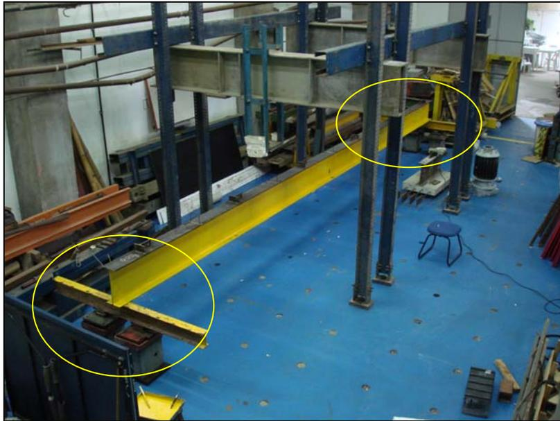
Figura 4.6 – Sistema de apoios: móvel e fixo – vão de 8,8m.
