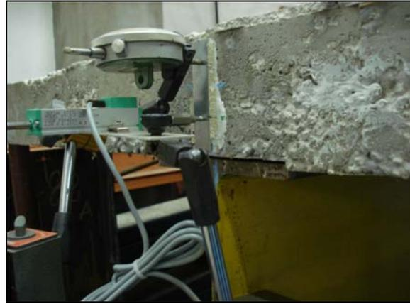
(b) Deslizamento e separação vertical
