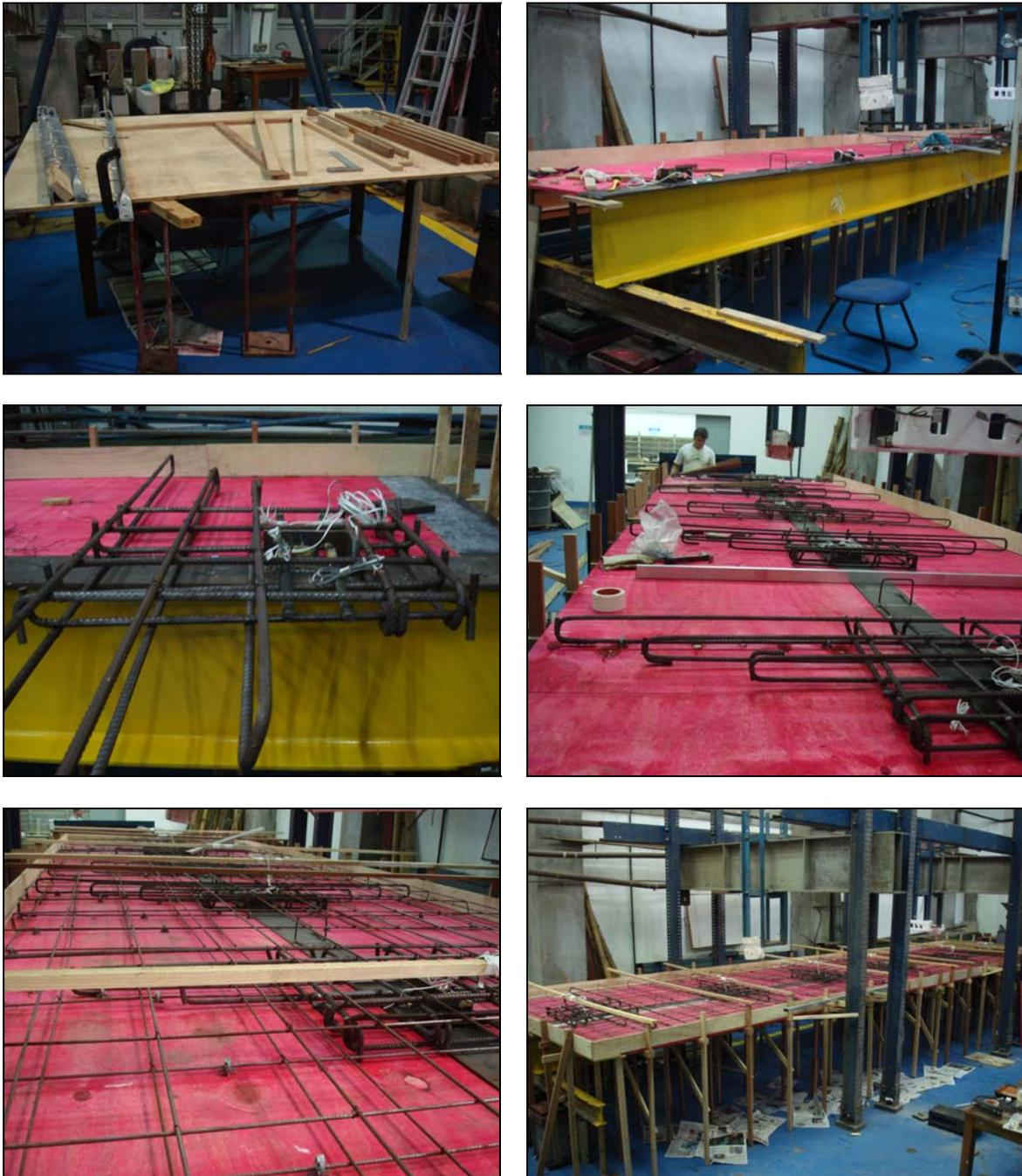
Figura 4.7 – Montagem das armaduras e formas no LEM.
