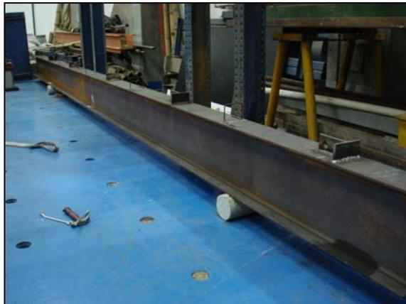
Figura 4.2 - Configurações do perfil da viga de 9,0m, W410x60
