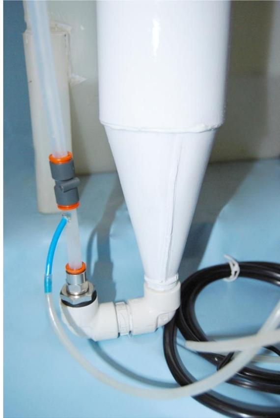
**Figura 12: Detalhe do *air-lift* utilizado na recirculação de lodo**
