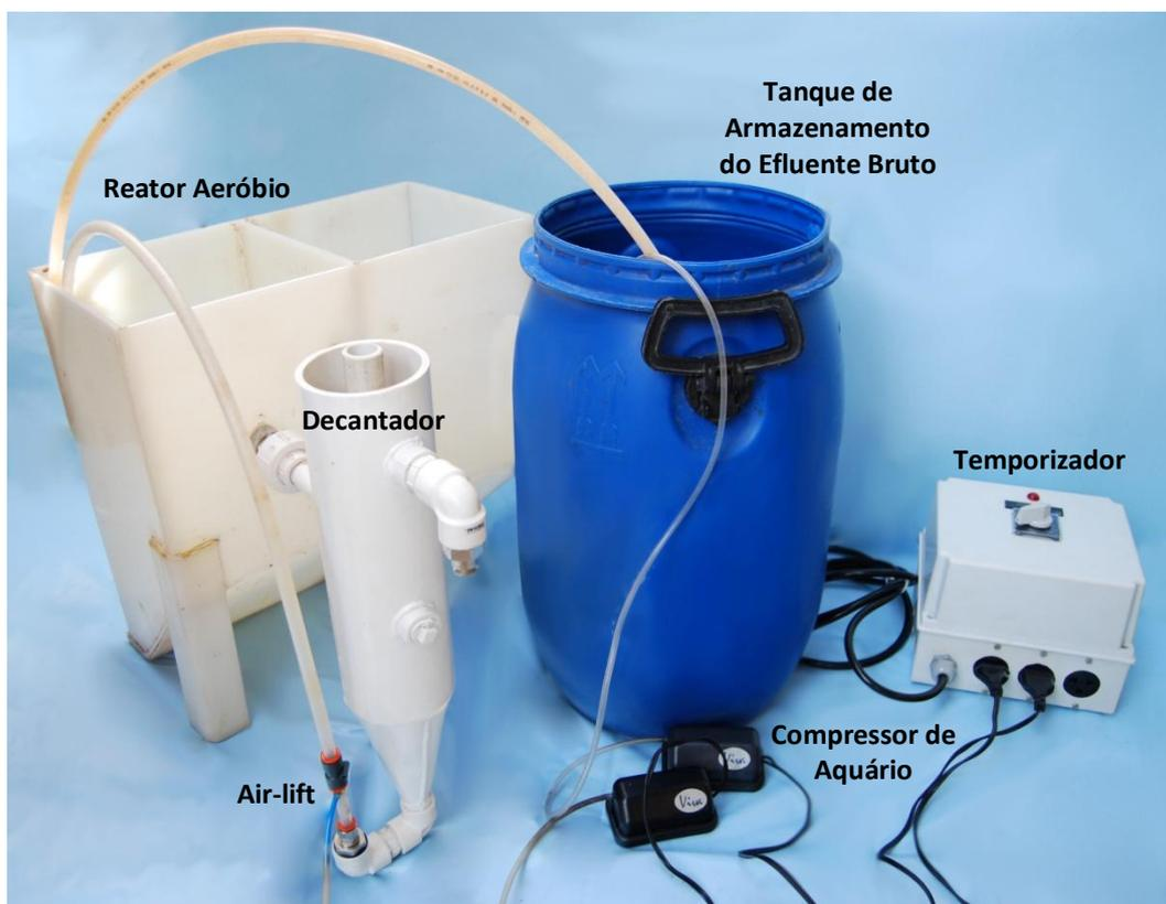
**Figura 11: Detalhe da montagem do experimento, incluindo: reator aeróbio de lodos ativados, decantador, sistema de air-lift, compressor de aquário, tanque de armazenamento do efluente bruto**
