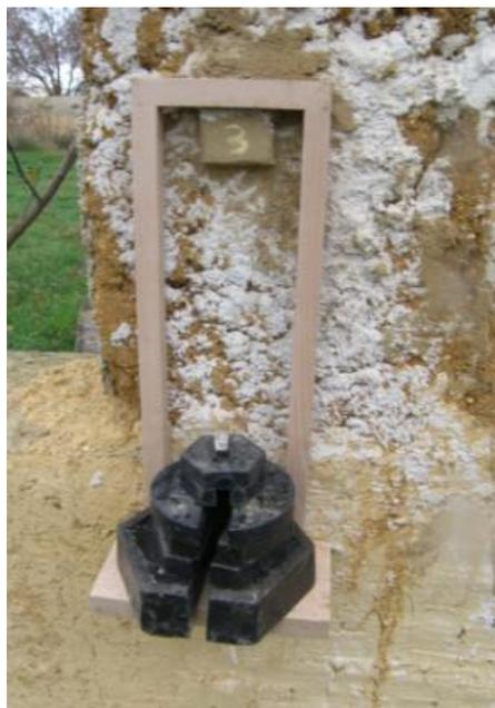
Figura 3.14: Exemplo do teste de cisalhamento – TA 9% suportando 10,1 kg.
