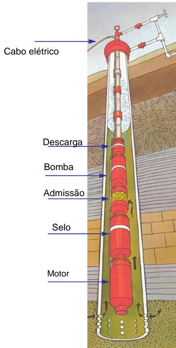
Figura 2-2 - Principais componentes do conjunto de BCS.
