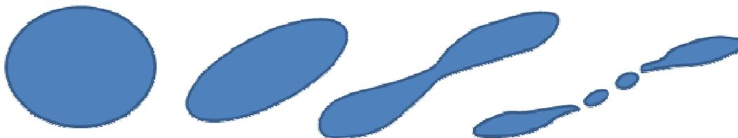
Figura 2-13 Mecanismo quebra de gota por cisalhamento. (Adaptado de Olbricht, 1996)
