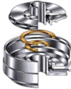
Figura 2-1 – Desenho simplificado de um estágio de uma BCS composto de um impelidor e um difusor.
