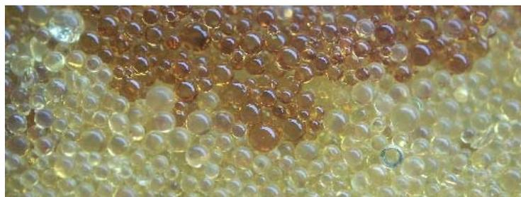
Figura 2.5: Resinas em forma de pérolas. Resina catiônica (parte superior) e aniônica (parte inferior). Fonte: referência [61].
