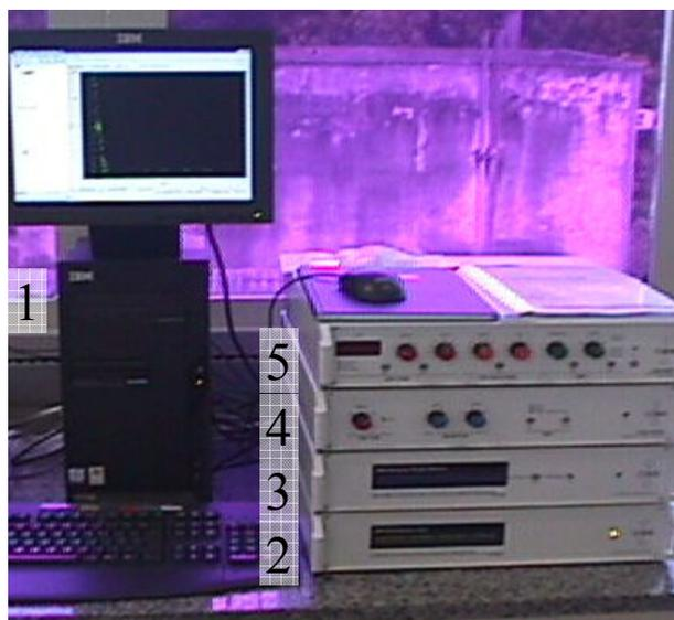
Figura 5.2. Fotografia do Sistema de Fluorescência resolvida no tempo Horiba-Jobin Ivon-IBH. 1: Computador; 2: DataStation Hub (Controlador de NanoLEDs, monocromadores, polarizadores, lentes e detector de fótons TBX); 3: Fonte e controle para o detector MCP; 4: Fonte e controle para lâmpada de Xenônio ; 5: Fonte e controle para lâmpada NanoFlash.
