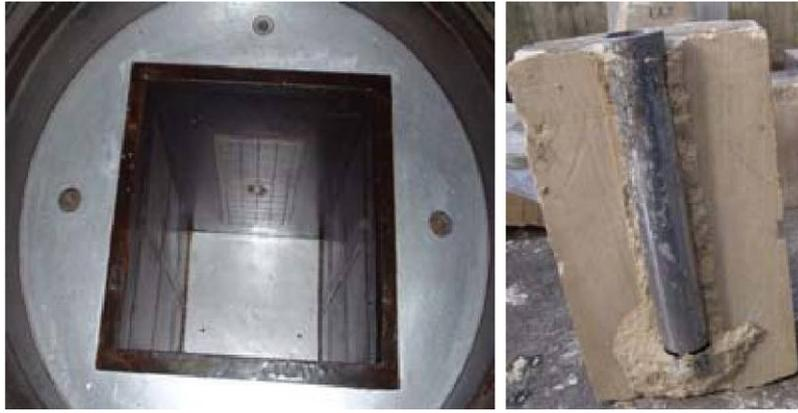
Figura 4.3 – Célula cúbica para ensaios de estabilidade (Morita et al. 2002)
