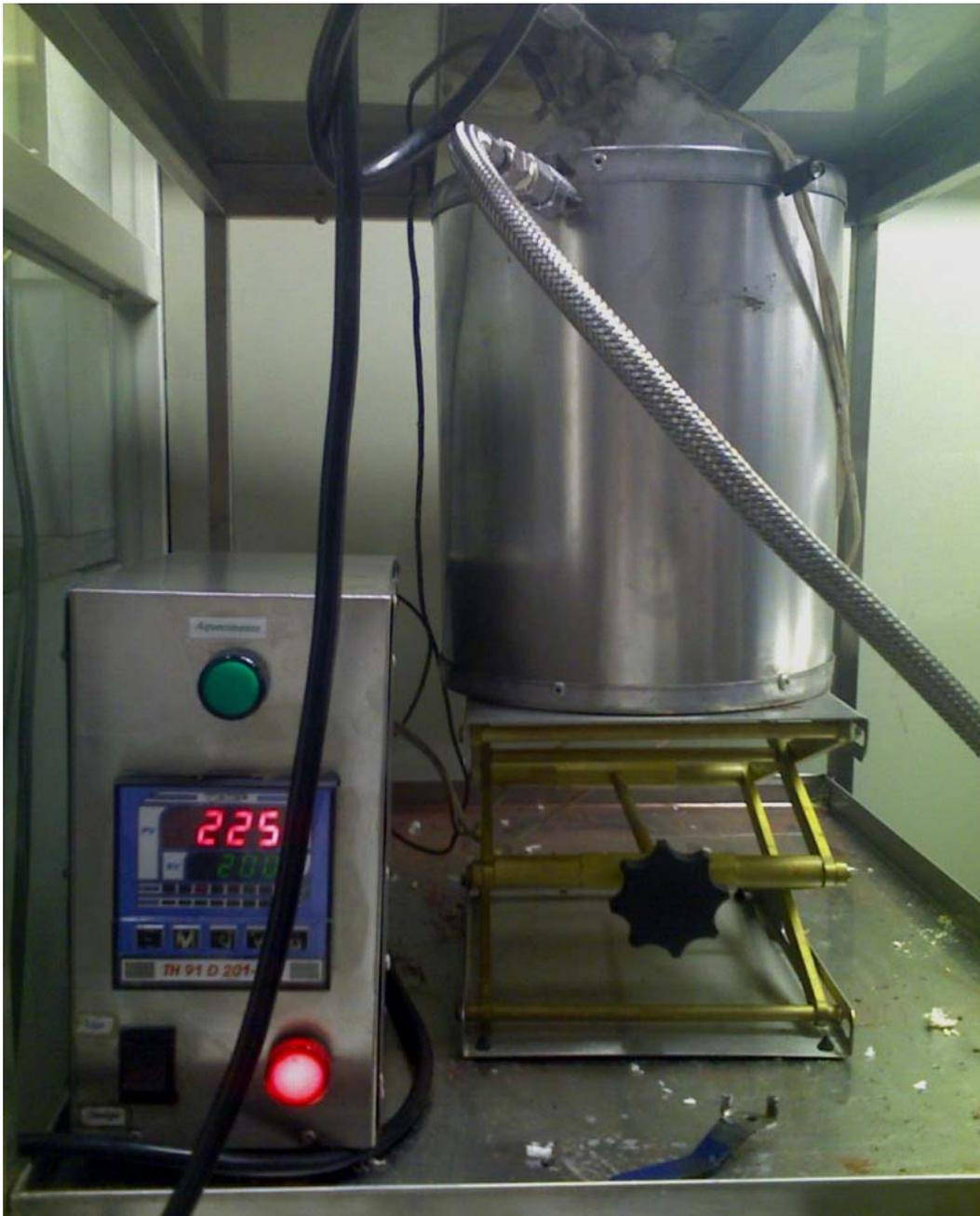
**Figura 4.3 – Destaque para o controlador de temperatura e entrada de gás inerte para o volatilizador.**
