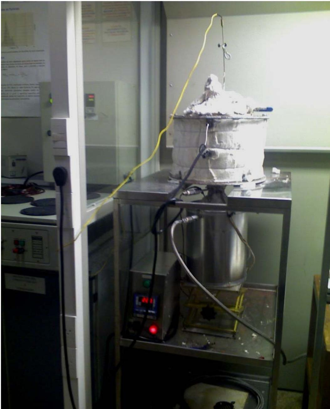
**Figura 4.2 – Bancada móvel com o conjunto reator e volatilizador e caixa controladora.**
