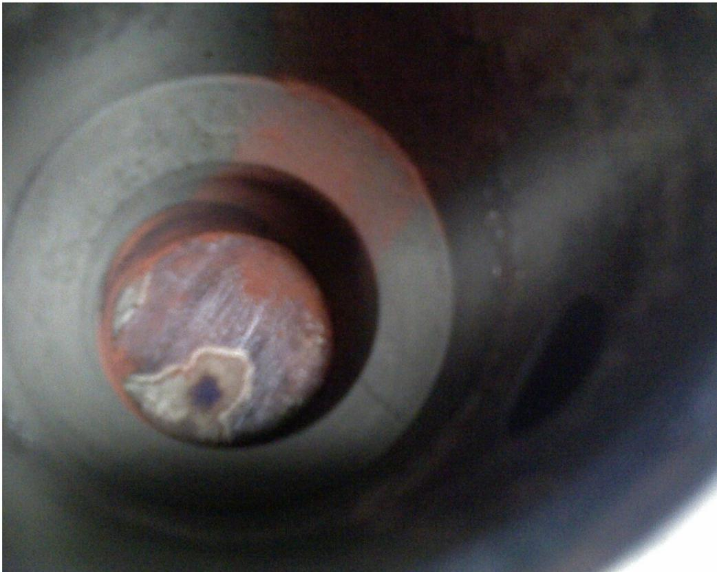
**Figura 4.6 – Vista superior interna do reator, destacando o alargamento de seção e a placa porosa.**
