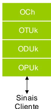
Figura 41 - Representação da estrutura de camadas simplificada.
