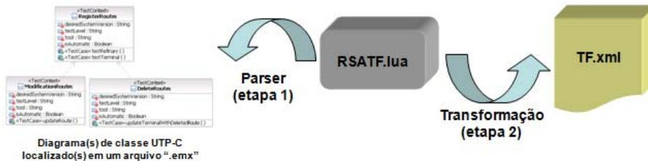
Figura 43. Transformação realizada pelo componente RSATF.lua.
