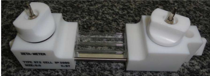
Figura 33- Célula de acrílico do zeta-meter +4.0.
