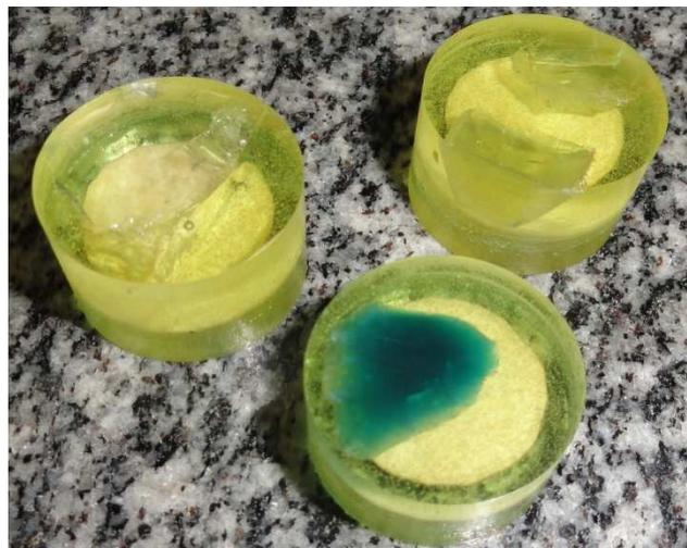
Figura 35- Seções polidas de amostras minerais, Quartzo e apatita.
