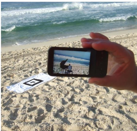
Figura 2-11 - Sistema de Realidade Aumentada em celular utilizando um marcador fiducial, que identifica a posição do usuário "de fora para dentro".
