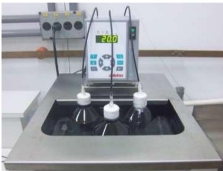
Figura 30 – Frascos no banho termostático sem a tampa
