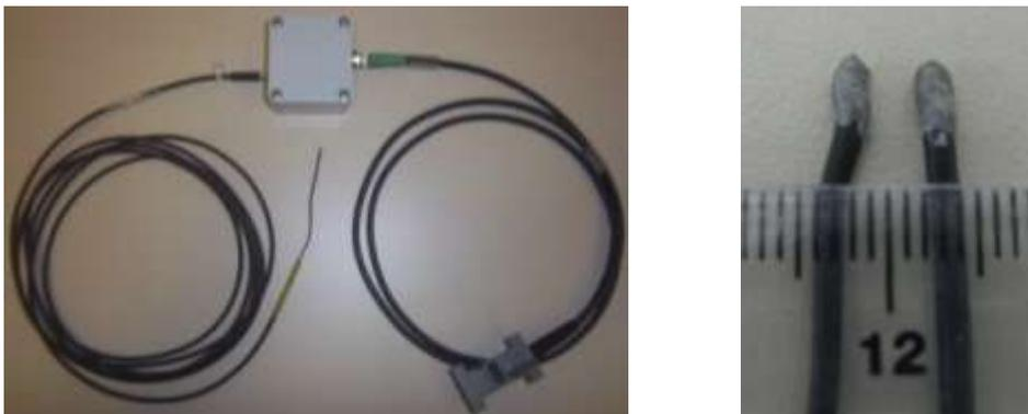
Figura 22 – Dispositivo de medição (esquerda) e sensores de esfera quente (direita)
