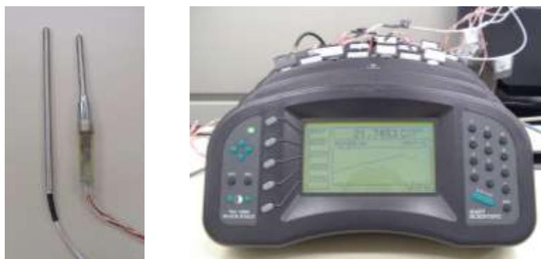
Figura 23 – Termômetros de resistência de platina (esquerda) e indicador digital (direita)
