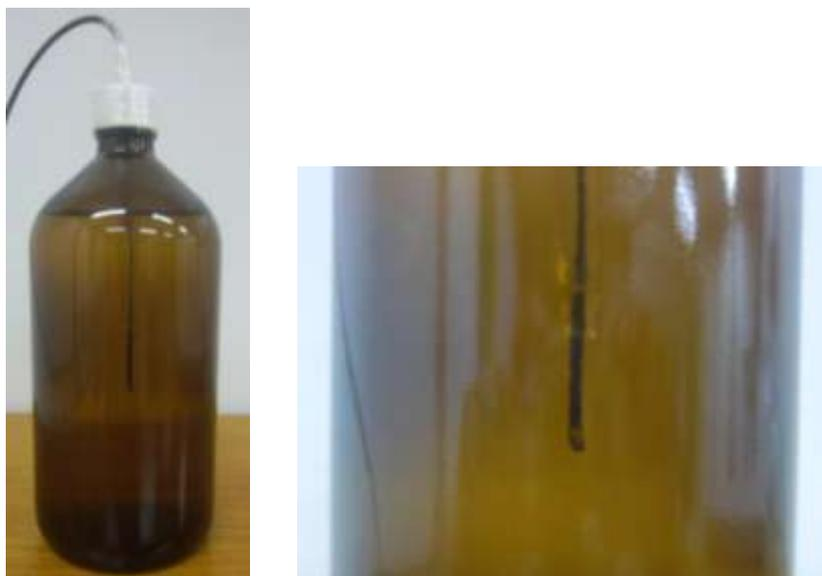
Figura 29 – Frasco com amostra e sensor de esfera quente no interior
