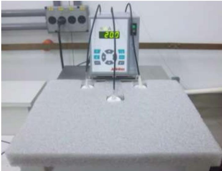
Figura 31 – Frascos no banho termostático com a tampa
