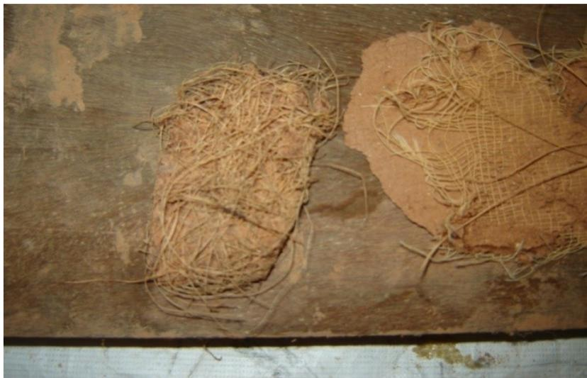
Figura 51: Pedacos de película de resina vegetal com barro: a da esquerda, aplicada diretamente sobre o fibrobarro e posteriormente arrancada, formando um *couro cabeludo* com as fibras de sisal do fibrobarro; a da direita, aplicada sobre tela de gaze sobre fibrobarro, após ser arrancada, incorporando apenas a gaze, sem aderir ao sisal.
