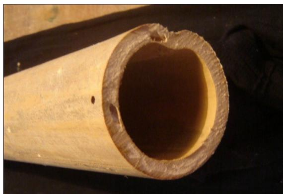
Figura 63: Bambu perfurado e cortado, mostrando sulcos deixados por larvas de *tigre* e um furo de saída do besouro.
