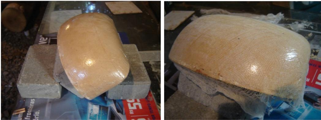
Figura 68: Meia-forma forrada com filme de PVC. À direita, primeira camada de gaze assentada sobre demão de resina.
