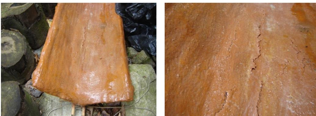
Figura 48: Telha acomodada sobre pedras no piso do LILD. Ver no detalhe algumas rachaduras que a película de barro e resina sofreu sobre a tela de gaze, permitindo o ingresso de água. A gaze, apesar de descolar do fibrobarro, manteve-se íntegra, sem rasgar ou esgarçar.
