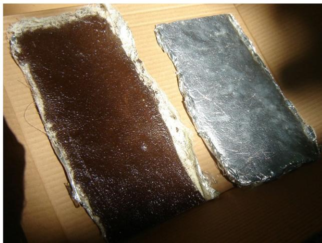
Figura 72: Placas planas. A da esquerda com a face resinada visível e a da direita com a face de alumínio.
