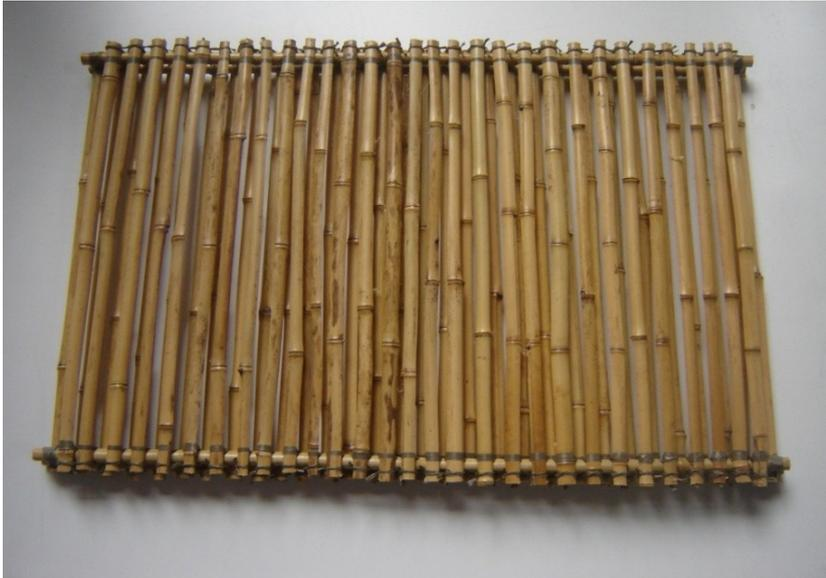
Figura 23: Com dois quadros de fitas de bambu superpostos. Ainda é perceptível a visão do fundo, onde estão apoiados os quadros, mostrando que a máscara formada pelas fitas não compõe veladura completa, o que indica a necessidade de uma terceira camada de fitas.
