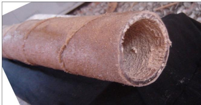
Figura 67: Foto tomada em 14/02/13, ou seja, com mais de um ano de exposição; observar a ação do caruncho na borda não protegida.
