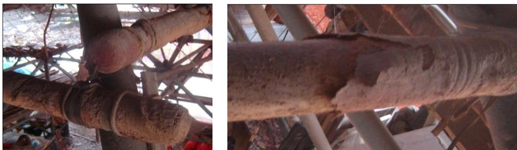
Figura 58: Bambus com tipos variados de tratamento. PVA, gaze e barro; PVA e barro. Foto tomada em 13/01/13.
