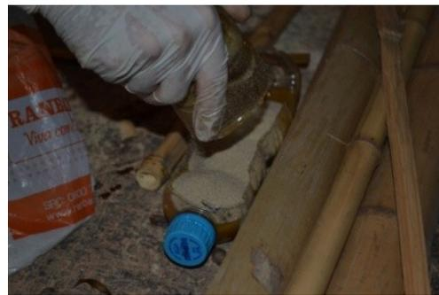
Figura 65: Colmo pintado de resina e envolvido com gaze aguardando a aplicação da camada de areia com resina, em preparo na imagem à direita.
