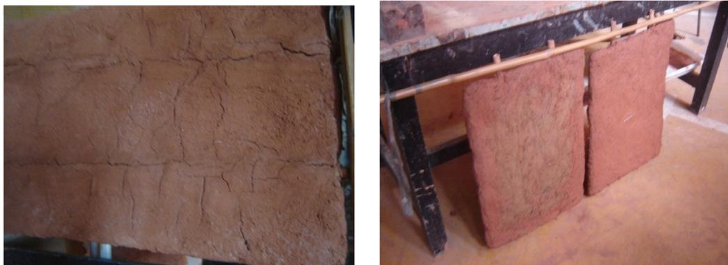
Figura 30: Lâmina em processo de secagem apresentando rachaduras cujas principais estão na horizontal, sobre as varas de bambu atravessadas, onde ocorre a flexão da manta sobre essas costelas de bambu. As rachaduras, porém, estão presentes em outras direções ao longo de toda a placa. Na outra imagem, as lâminas já estão com as superfícies recuperadas, em processo de secagem.
