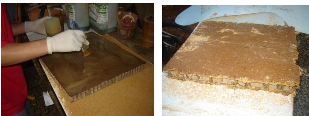
Figura 39: Aplicação de resina na face do *honey-comb* autoestruturado. Na imagem à direita, o painel já composto. Devido ao elevado consumo de resina não houve interesse em concluir a impermeabilização superficial.
