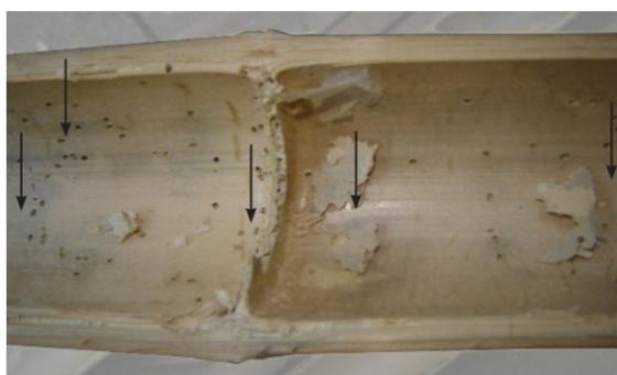
Figura 57: Pó resultante da ação do caruncho, cujo ciclo de desenvolvimento das larvas ocorre no interior das paredes do bambu. No detalhe, furos no nó, nos entrenós e paralelos às paredes do colmo, tanto no sentido das fibras, quanto no transversal.
