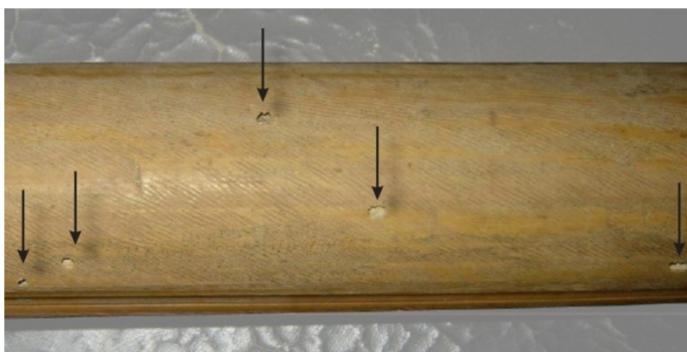
Figura 56: Colmo de *mossô* com a superfície recartilhada<sup>16</sup> por lâmina de serra, perfurado por *tigre*, antes de ser concluída a laminação do processo de proteção.
