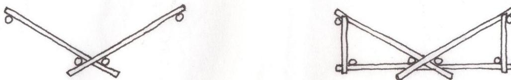
Figura 49: Corte esquemático; à esquerda como foi executada a estrutura da telha e, à direita, uma hipótese com peças complementares fazendo a triangulação das abas, para maior rigidez.
