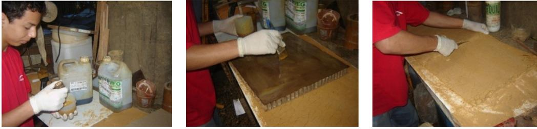
Figura 74: No experimento do painel, o aprendiz efetuando a mistura dos componentes da resina poliuretânica vegetal, aplicando a resina sobre peça de *honey-comb* estruturado de celulose e cortando manta de fibrobarro.
