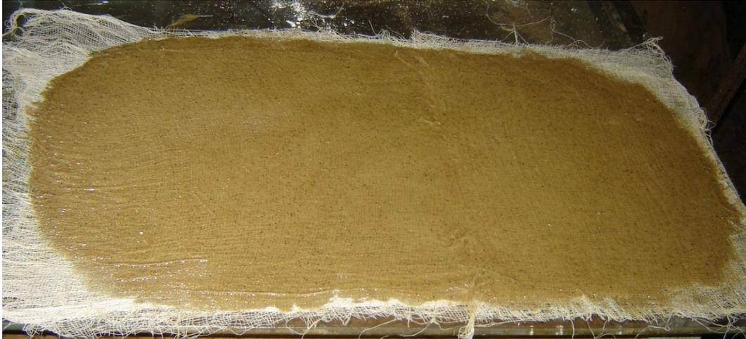
Figura 73: Placa plana com 0,80 cm x 0,40 cm, secando sobre a bancada.
