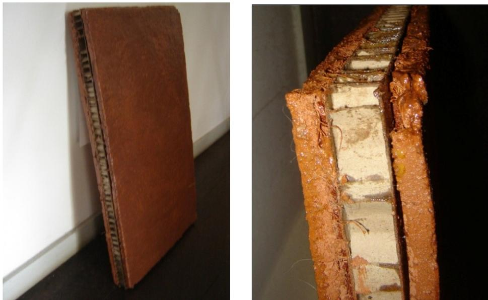
Figura 40: Painel sanduíche de fibrobarro com miolo em colmeia de *honey-comb* e acabamento superficial impermeabilizante em resina vegetal. Este painel ficou exposto no Solar Grandjean de Montigny como peça produzida no LILD para a exposição “Encontros no Solar – Técnicas Convivenciais - Bambu e Terra 2010”.
