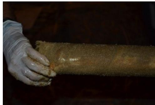
Figura 66: Aplicação diretamente com as mãos da camada de areia e resina, na proporção de 1:5, vendo-se na imagem à direita o colmo recoberto.
