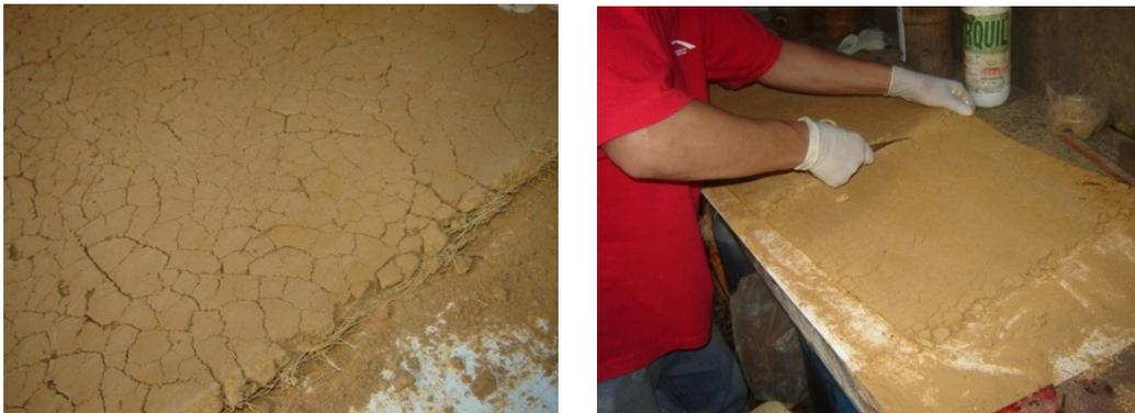
Figura 36: Manta de fibrobarro seca, sendo visível a trama de pequenas rachaduras devido à retração do barro, estruturado pelas fibras de sisal. O aprendiz executando o corte da manta à faca, o que demonstra a facilidade de manusear uma manta.
