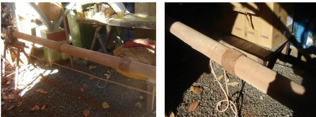
Figura 61: Colmo preso à máquina de girar, já com as bandagens confeccionadas. À direita, detalhe da bandagem aplicada sobre o colmo lixado.
