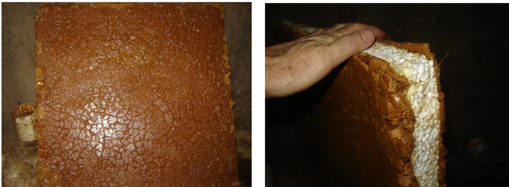
Figura 37: Face do painel impermeabilizada, percebendo-se a trama de rachaduras superficiais do fibrobarro. Painel visto de topo, mostrando o acabamento irregular da borda do fibrobarro cortado à faca, que, mesmo recebendo resina, não ficou uniformemente impermeabilizada.
