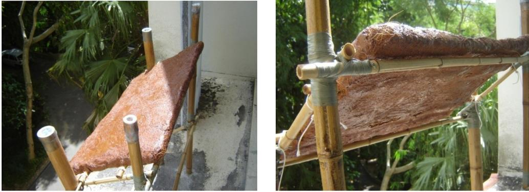
Figura 31: Observa-se o encabeçamento com garrafas PET deformadas por calor. O brilho na superfície do fibrobarro é resultado da aplicação de resina. No momento do registro fotográfico, apenas a bandeja superior, com a manta reaproveitada, estava colocada.
