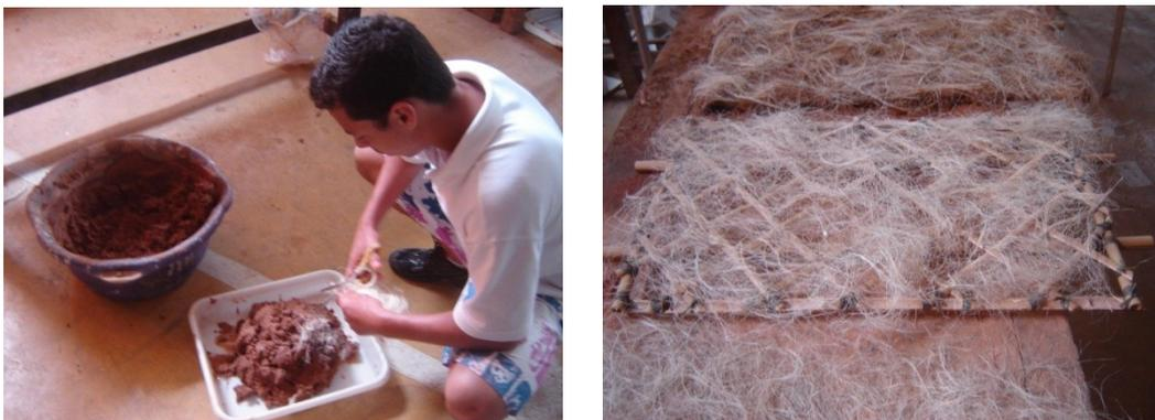
Figura 29: O aprendiz corta, com tesoura escolar, fibras de sisal que serão misturadas ao barro úmido. Na outra imagem vê-se o sisal desfiado sobre as bandejas, tendo ao fundo a bandeja com a manta reutilizada por baixo, já no início de preparo da face superior.
