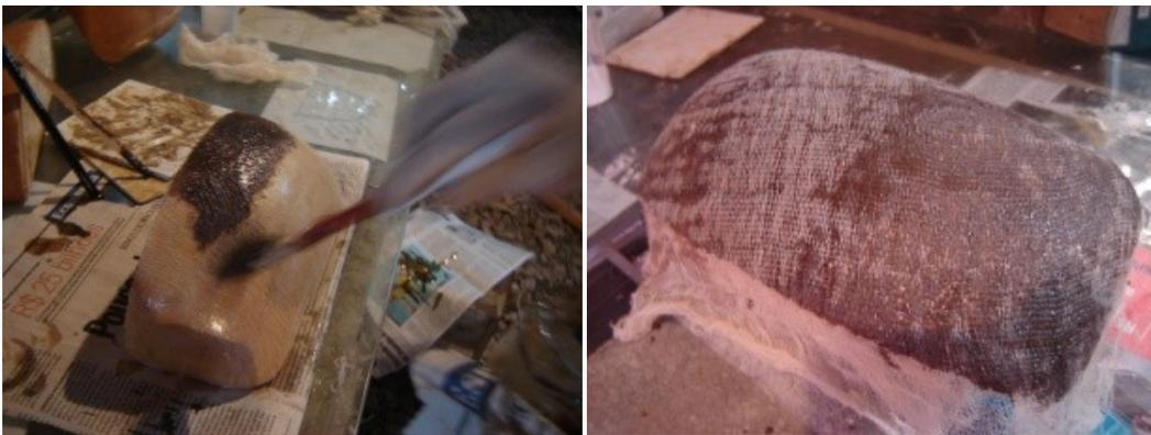
Figura 70: Aplicação da primeira camada da mescla. À direita, colocação da segunda camada de gaze sobre a resina úmida.
