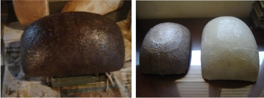
Figura 71: Primeiro molde deformado. À direita os dois moldes concluídos, percebendo o remendo no topo do molde que representa a forração interna da maquete.
