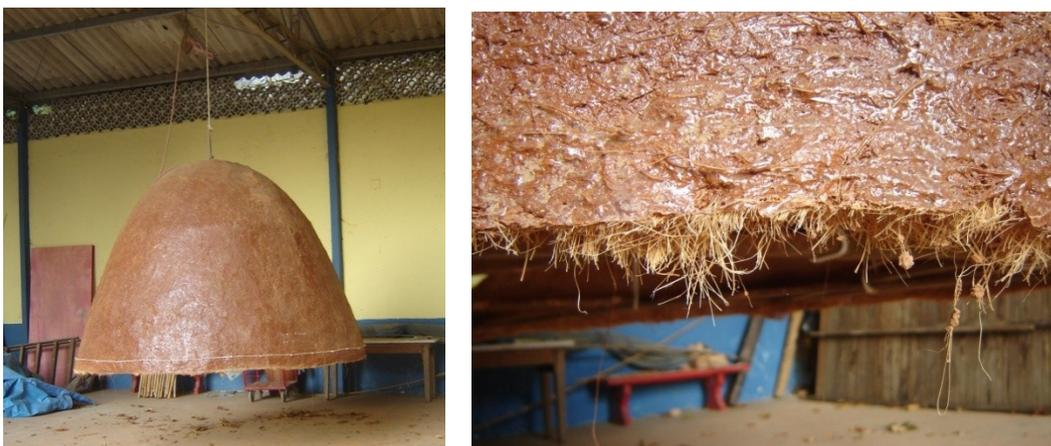
Figura 42: Cúpula de fibrobarro projetada a partir do desenvolvimento de uma curva catenária, moldada sobre fôrma perdida de areia, com altura de 1,80m e diâmetro de 2,40m. No detalhe percebe-se a aplicação da resina poliuretânica vegetal pelo brilho da superfície externa e a borda inferior expondo a terra crua e as fibras de sisal, sem resina. Leme, 2008 e Alvares, 2008.
