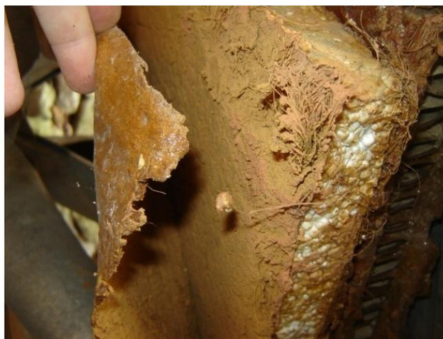
Figura 38: Painel de fibrobarro com miolo de isopor, após exposição às intempéries.
