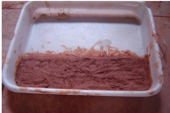
Figura 32: Percebe-se o aparecimento de rachaduras na superfície do barro já no terceiro dia de exposição. Nesse momento o barro ainda se encontrava bastante úmido.
