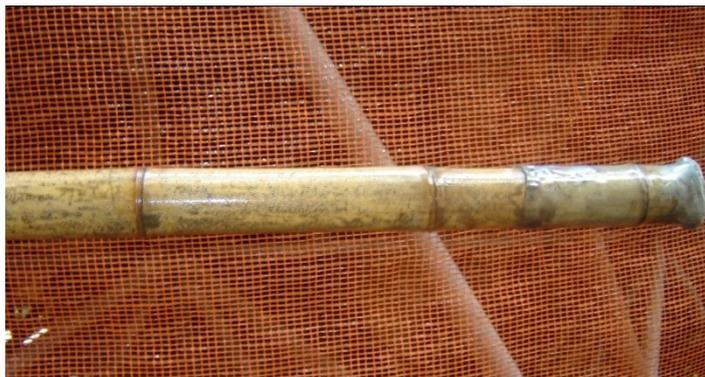
Figura 59: Foto, tomada em 08/01/13, de um bambu tratado com solução de água, querosene e sal, preservando ainda a ponteira de vedação inferior em PET.
