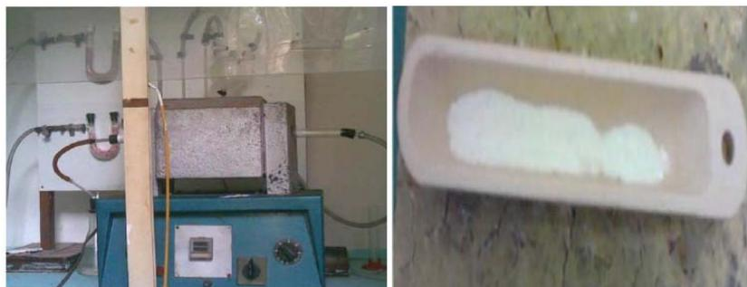
Figura 37 Linha utilizada nos processo de redução das amostras de MgO/Ni e barquinha de cerâmico utilizado para pesar as amostras.
