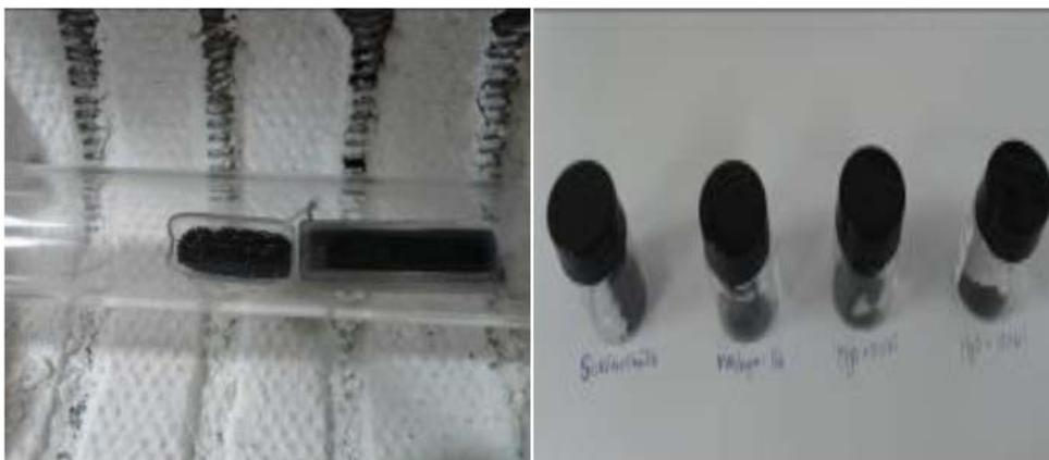
Figura 36 Amostras após o crescimento de nanotubos de carbono pelo método *High Vacuum Chemical Deposition Vapor (CVD)*.
