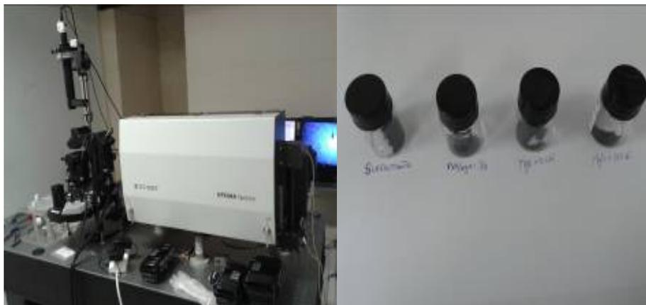
Figura 41 Espectroscópio Raman (NTEGRA Spectra NT-MDT), e amostras de catalisadores após o crescimento de nanotubos de carbono.
