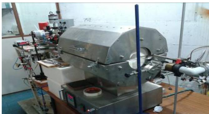
Figura 34 Equipamento de High Vacuum Chemical Vapor Deposition (CVD), departamento de física PUC-Rio.
