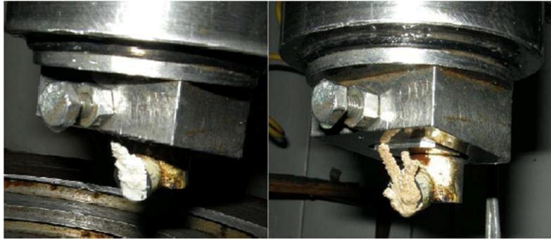
**Figura 2.26: Aglomeração de material a frente do cortador após o experimento. Extraído de Rafatian *et. al.* (2009).**
