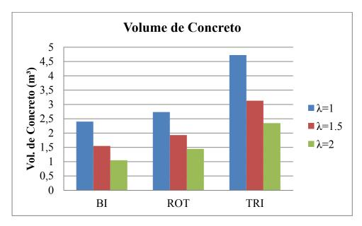
Figura 5.3 – Gráfico comparativo entre volume de concreto das nervuras no caso 1.
