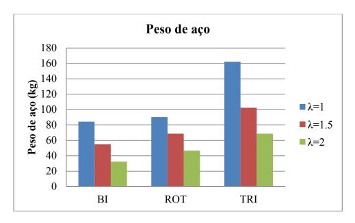
Figura 5.2 - Gráfico comparativo entre peso de aço nas nervuras no caso 1.
