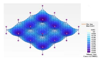
Figura 5.9 – Deslocamentos da laje com faixas nervuradas.
