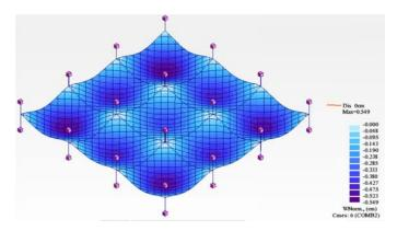
Figura 5.8 – Deslocamentos da laje rotacionada.
