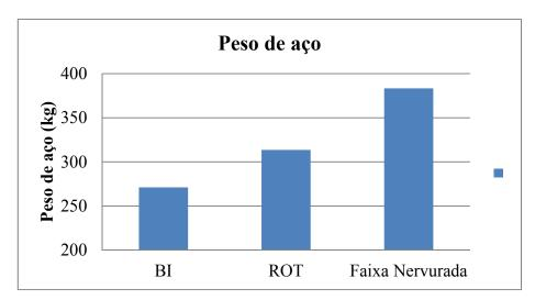
Figura 5.11 - Gráfico comparativo entre peso de aço das nervuras e vigas faixa.
