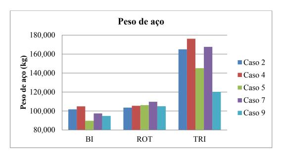
Figura 5.5 – Gráfico comparativo entre peso de aço nas nervuras.
