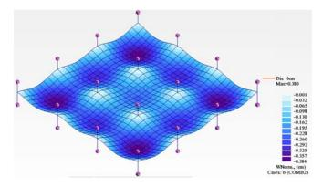
Figura 5.7 - Deslocamentos da laje bidirecional.
