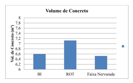
Figura 5.12 – Gráfico comparativo entre volume de concreto das nervuras e vigas faixa.
