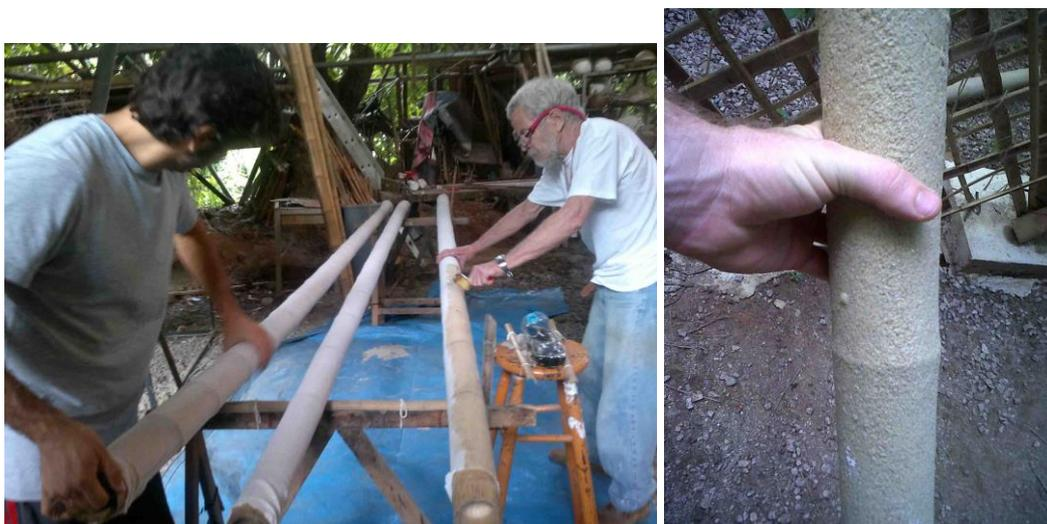
Figura 20: experimentando a técnica de encapsulamento em ambiente situacional sob a supervisão do professor J.L.M. Ripper, aspecto visual do bambu encapsulado, LILD PUC-Rio, 2012.
