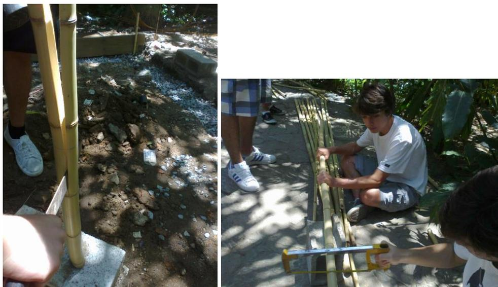
Figura 15: corte do colmo de bambu caniço no sentido transversal e abertura em meia-cana no sentido longitudinal, Escola Parque, 2012.
