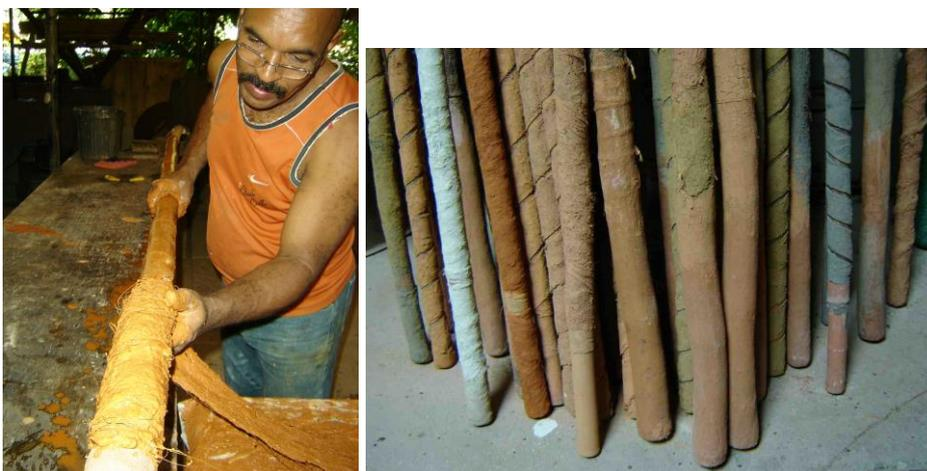
Figura 19 : o técnico Mariano praticando o encapsulamento de bambus, experimentação de diversas técnicas no LILD PUC-Rio, 2002.
