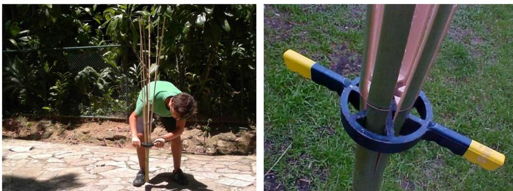
Figura 25: Técnica de abertura dos colmos de bambu caniço em fitas com o *bamboo splitter*, Escola Parque, 2012.
