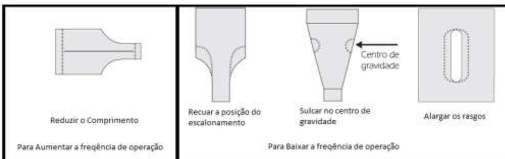
Figura 10-Tecnicas de usinagem para ajuste da frequência de operação dos sonotrodos[22]
