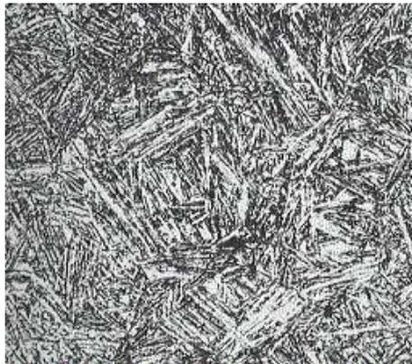
Figura 18D – Microestrutura martensita
