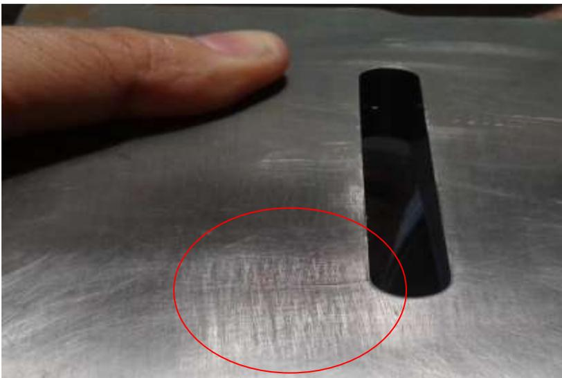
Figura 12 - Foto de um Sonotrodo tipo Faca – Trincado, Utilizado para este estudo, indicada pelo círculo vermelho.
