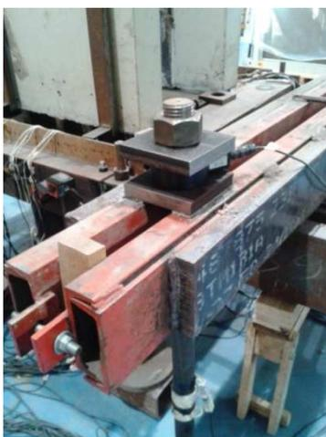
**Figura 3.61 – Perfis de travamento de segundo nível com adição das barras soldadas.**
