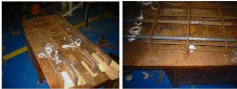
**Figura 3.6 – Extensômetros nas armaduras principais dos *pull outs* (Ramires, 2010).**
