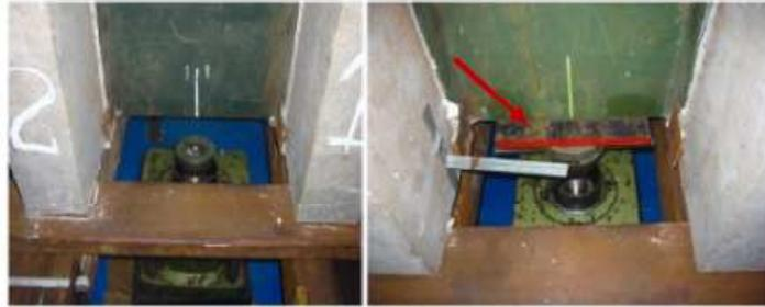
Figura 3.23 – Placa de distribuição de tensões (Ramires, 2010).
