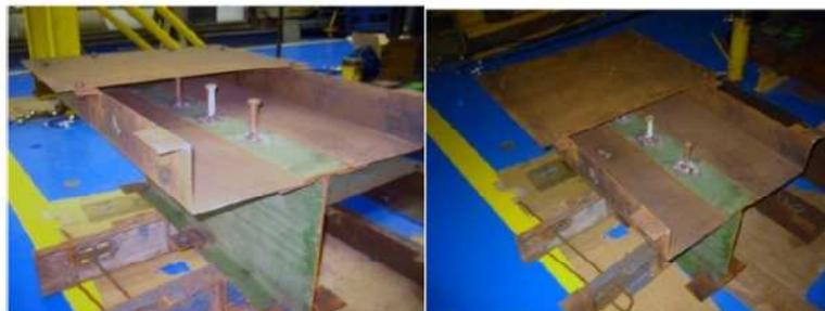
**Figura 3.10 – Forma metálica para os pré-ensaios (Ramires, 2010).**
