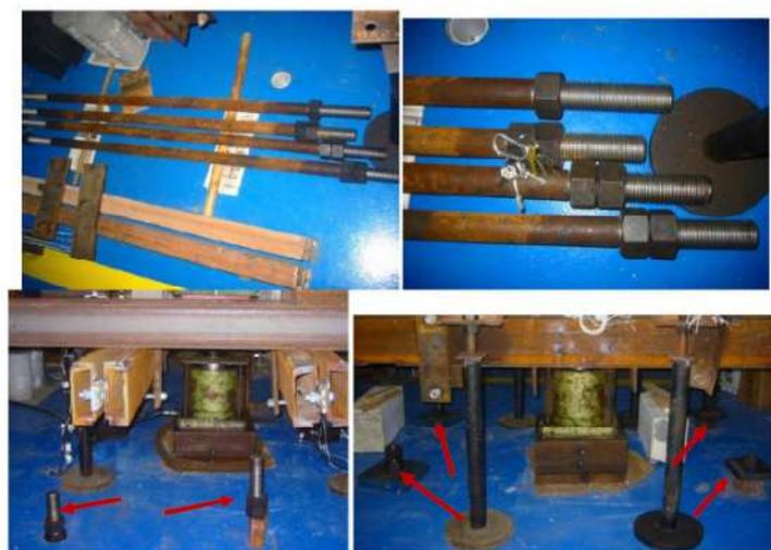
Figura 3.21 – Barras redondas posicionadas nos furos (Ramires, 2010).
