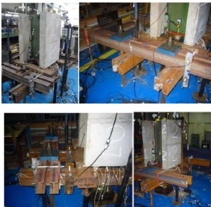
Figura 3.26 – Estrutura de travamento e *pull out* prontos para a execução do teste (Ramires, 2010).
