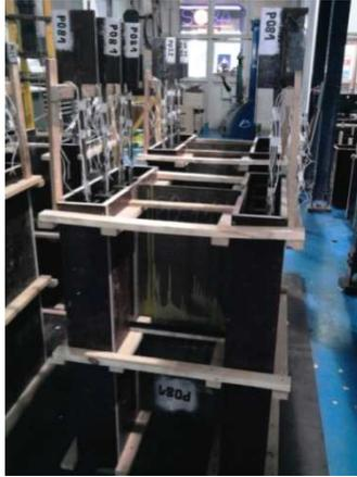
**Figura 3.48 – Formas das novas séries de ensaios.**
