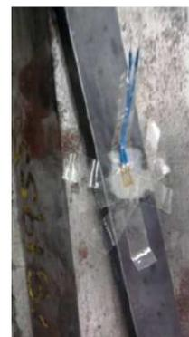
**Figura 3.56 – Extensômetros nos CPs de aço.**
