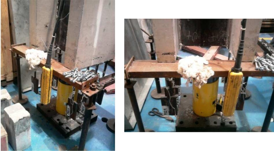
**Figura 3.63 – Posicionamento do ensaio sobre a mesa de apoio.**
