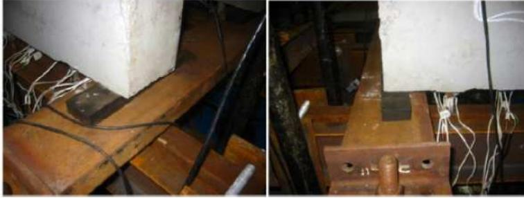
Figura 3.22 – Pontos de apoio em neoprene (Ramires, 2010).
