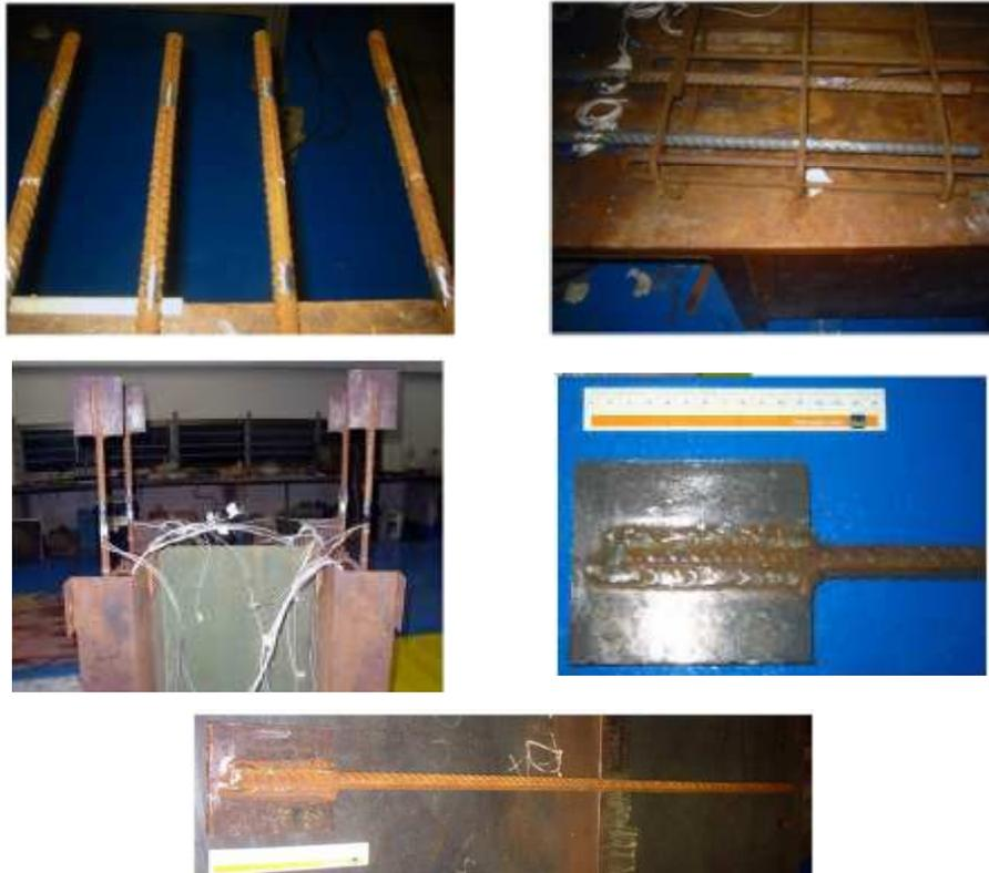
Figura 3.13 – Barra de armadura: detalhes e posicionamento dos extensômetros (Ramires, 2010).
