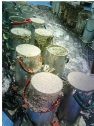
**Figura 3.49 – Preenchimento dos corpos de prova.**
