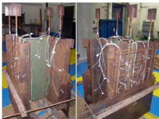
**Figura 3.29 – Posicionamento para concretagem do *pull out* (Ramires, 2010).**
