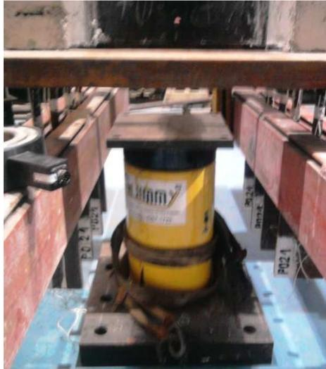
**Figura 3.65 – Conjunto atuador hidráulico e placa de aço.**
