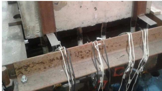
**Figura 3.66 – Fios ligados dos extensômetros.**
