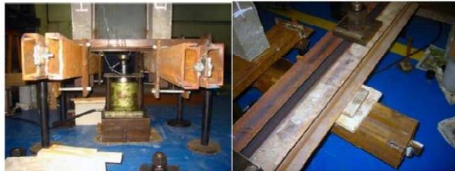
**Figura 3.19 – Sistema de travamento e posicionamento do atuador hidráulico (Ramires, 2010).**
