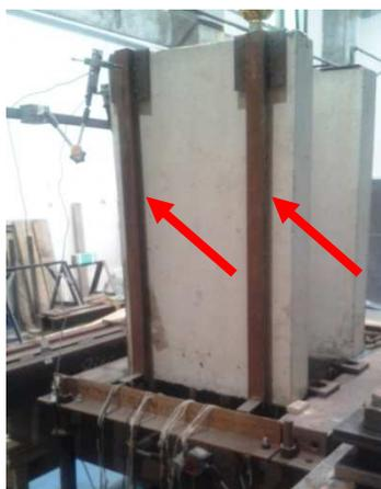
**Figura 3.68 – Barras retangulares para medição dos LVDTs.**
