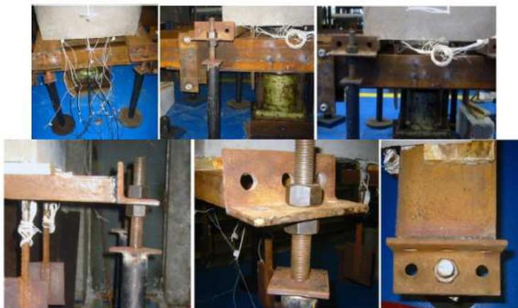
Figura 3.20 – Mesinhas de apoio dos *pull outs* (Ramires, 2010).
