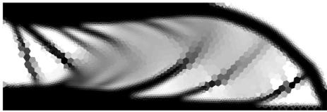
Figura 3.16: Domínio retangular com 1000 elementos iniciais no terceiro passo de penalização **antes** da adaptação da malha.
