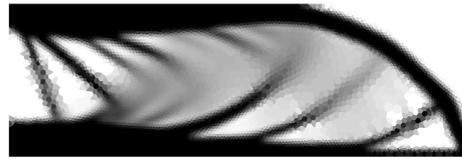
Figura 3.17: Domínio retangular com 1000 elementos iniciais no terceiro passo de penalização **após** a adaptação da malha.
