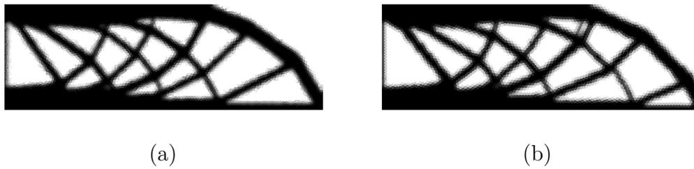
Figura 4.7: Topologia ótima do domínio MBB (Olhoff et al. (1991) (22)) com  $R = 0,04$  e  $\tilde{v} = 0,5$ : (a) com malha adaptativa partindo de 625 elementos e chegando a 5398 elementos; e (b) com malha refinada com 5000 elementos e mantida constante durante todo o processo de otimização topológica.
