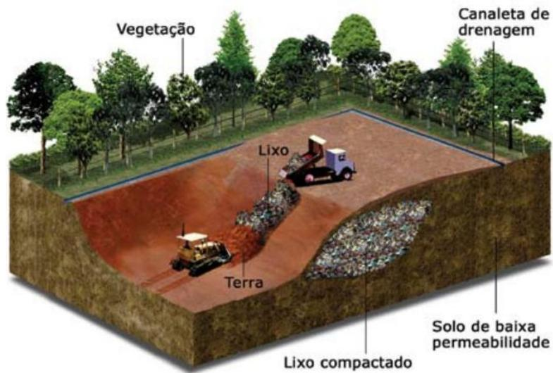
Figura 12: Aterro em Rampa, Caderno técnico de reabilitação de áreas degradadas por resíduos sólidos urbanos (FEAM, 2010).
