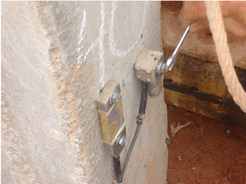
Figura 1 - Transdutores de aceleração (direita) e deformação (esquerda) fixados em uma estaca (Cortesia: Fugro In Situ Geotecnia Ltda)
