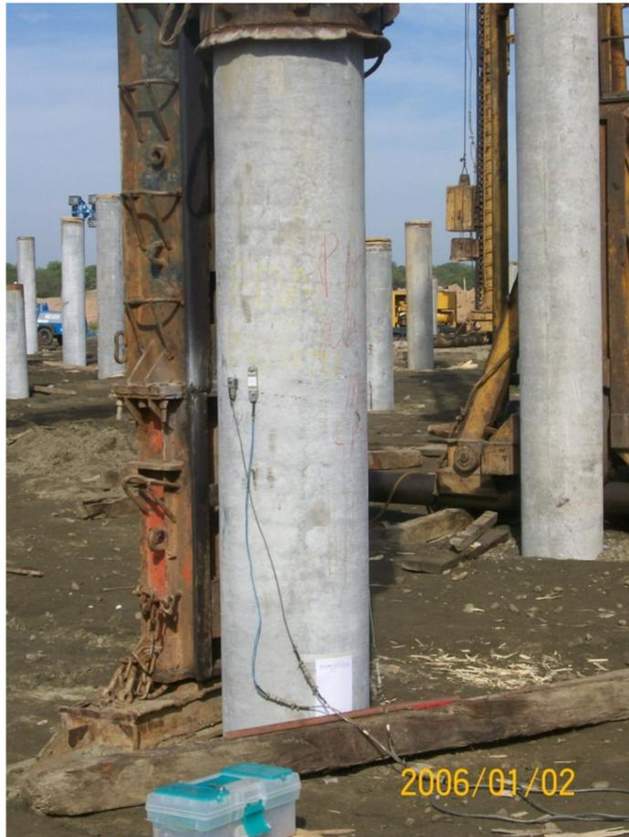
Figura 2 - Estaca instrumentada para ensaio dinâmico (Cortesia: Fugro In Situ Geotecnia Ltda)
