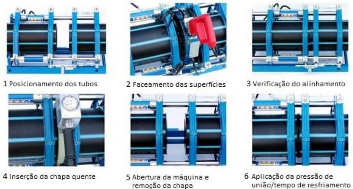
Figura 2-12– Etapas do processo de soldagem de topo através de máquina manual do tipo horizontal [24].
