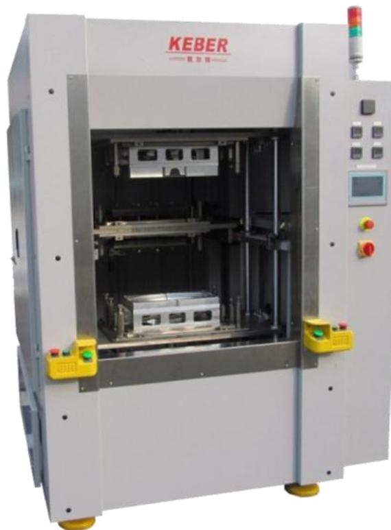
Figura 2-11- Máquina de solda por termofusão – tipo vertical [23].
