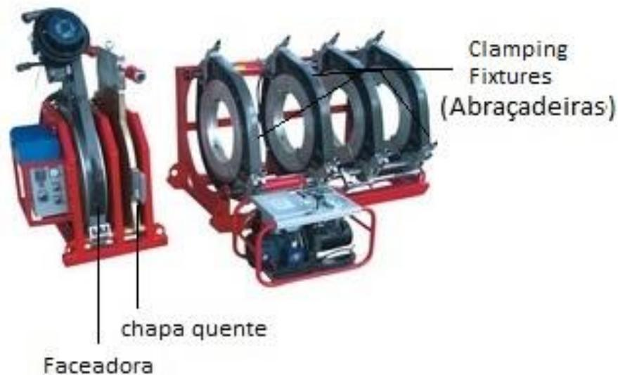
Figura 2-10 - Máquina de solda por termofusão - tipo horizontal [23].
