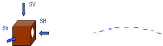
*Figura 4-15: poço perfurado perpendicular a tensão horizontal máxima ( $\sigma_H$ )*
