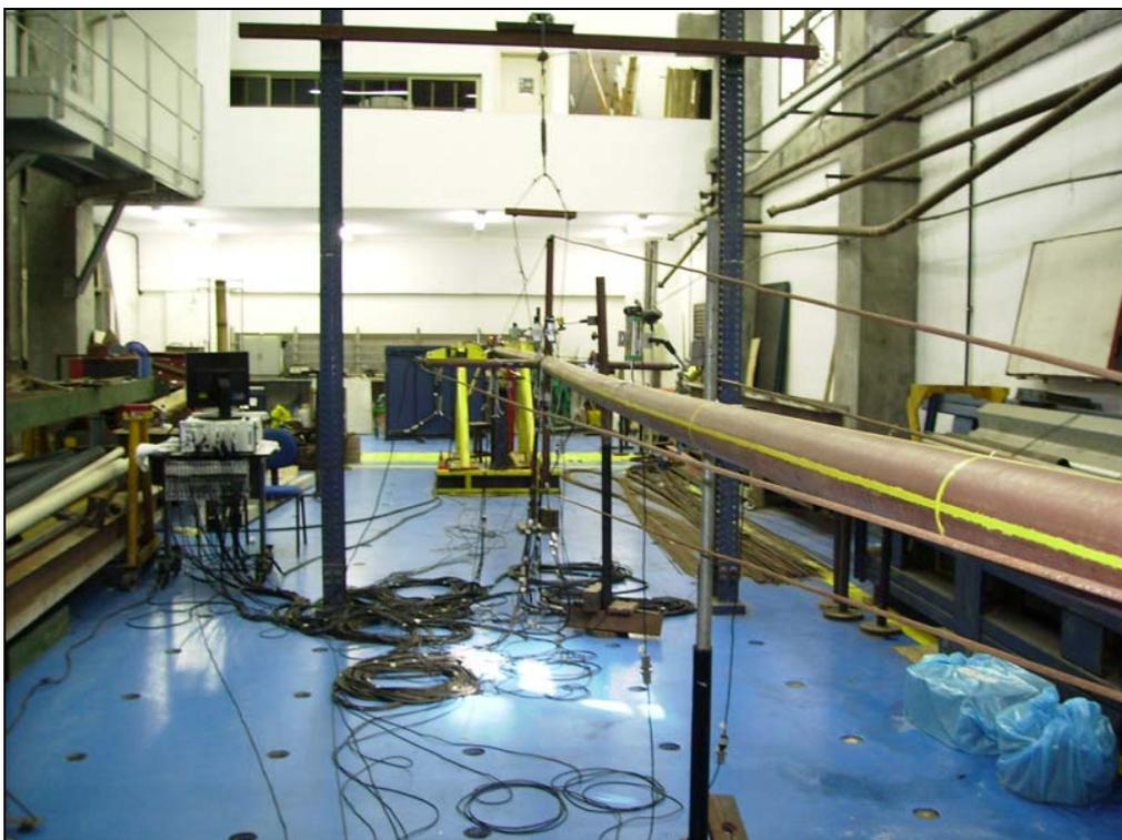
Figura 4.119 Visão oposta do ensaio apresentando o segundo modo de flambagem para terceira coluna em modo +.
