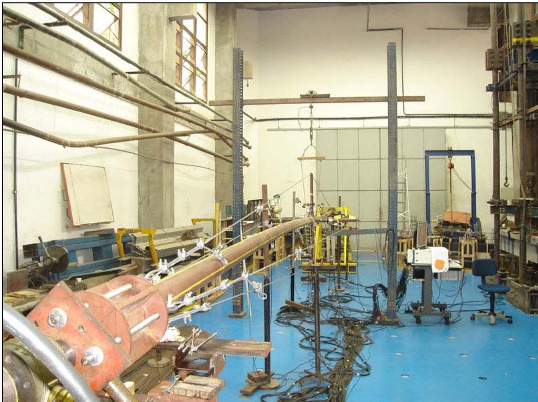
Figura 4.74 Ensaio apresentando o segundo modo de flambagem
