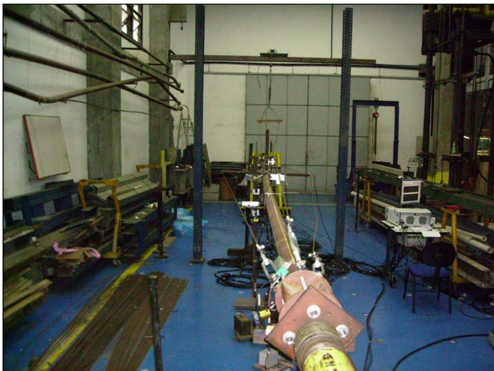
Figura 4.120 Ensaio apresentando o primeiro modo de flambagem para terceira coluna em modo +.
