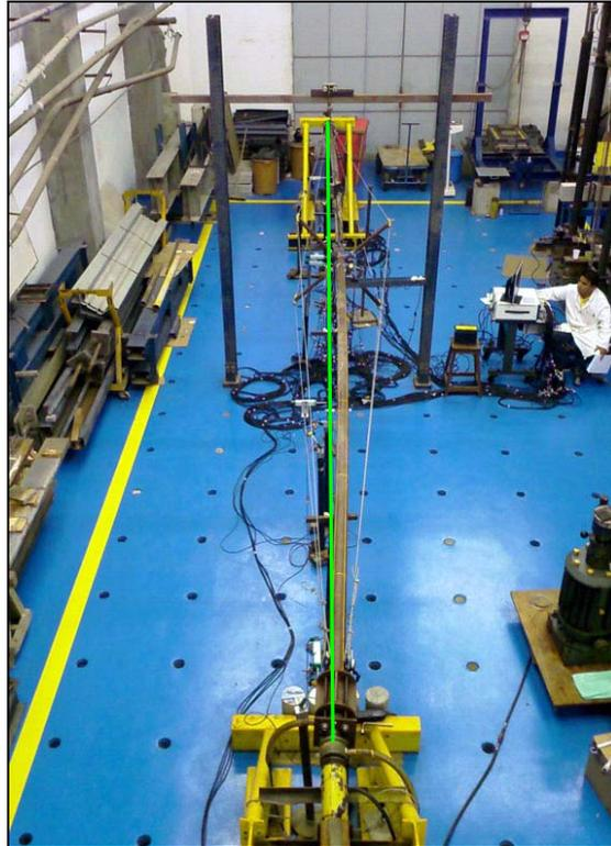
Figura 4.28 Ensaio da primeira coluna em modo x apresentando o primeiro modo de flambagem.
