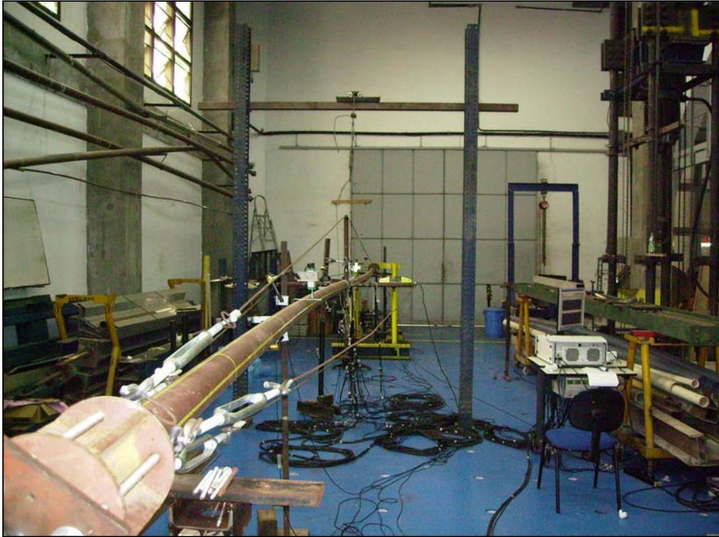
Figura 4.118 Ensaio apresentando o segundo modo de flambagem para terceira coluna em modo +.
