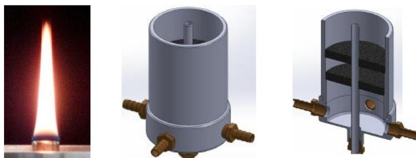
**Figura 15 - Chama não pré-misturadas de etileno e de ar, queimador Gülder e corte transversal do queimador**
