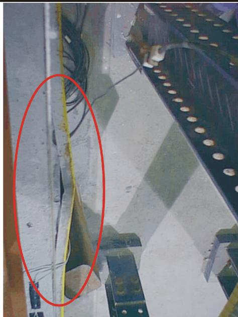
Figura 4.10 – Detalhe da flambagem distorsional – BMP-1.
