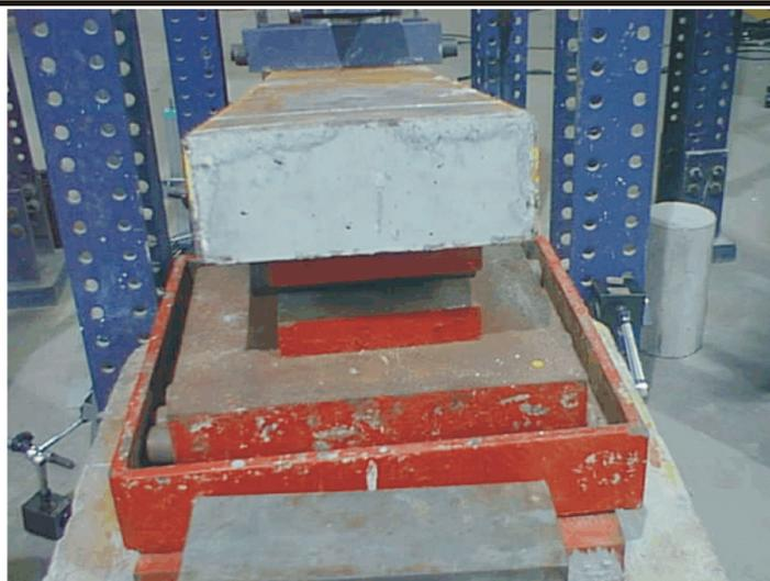
Figura 4.30 – Foto mostrando a ausência de deslizamento do concreto – BMN-2.
