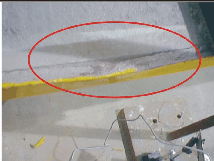
Figura 4.45 – Detalhe da flambagem distorsional – BMP-5.
