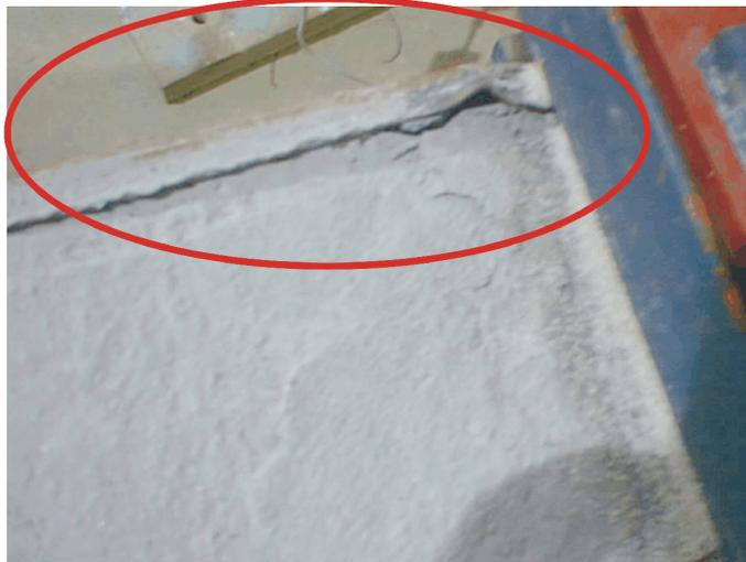
Figura 4.40 – Detalhe da flambagem distorsional da aba da fôrma – BMP-4.
