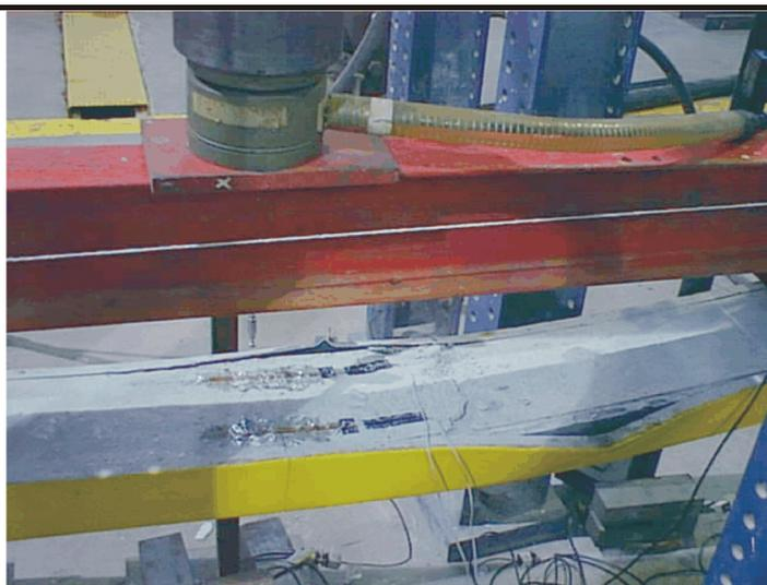
Figura 4.8 – Configuração final da laje após a ruptura do concreto – BMP-1.
