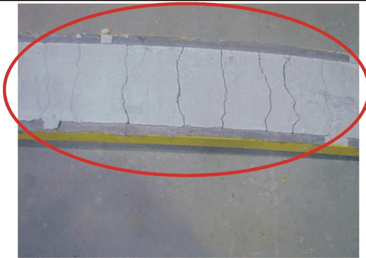
Figura 4.29 – Detalhe das fissuras da laje – BMN-2.
