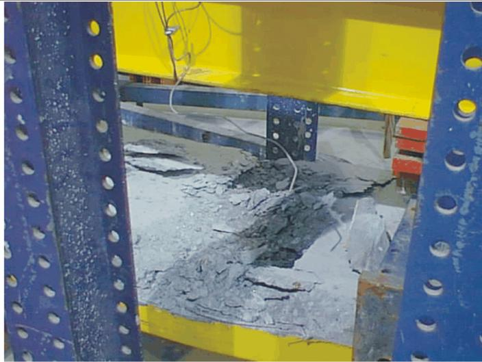
Figura 4.53 – Foto 2 da ruptura do concreto – BMP-7.
