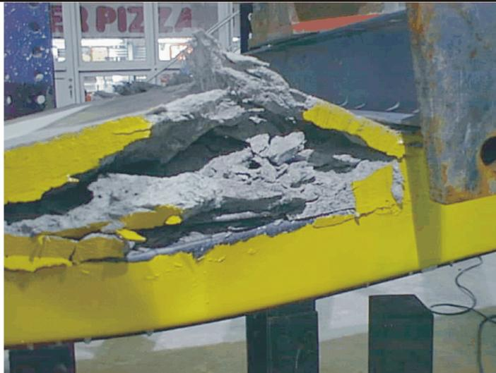
Figura 4.48 – Foto 2 da ruptura do concreto – BMP-6.
