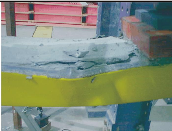
Figura 4.44 – Foto da ruptura do concreto – BMP-5.
