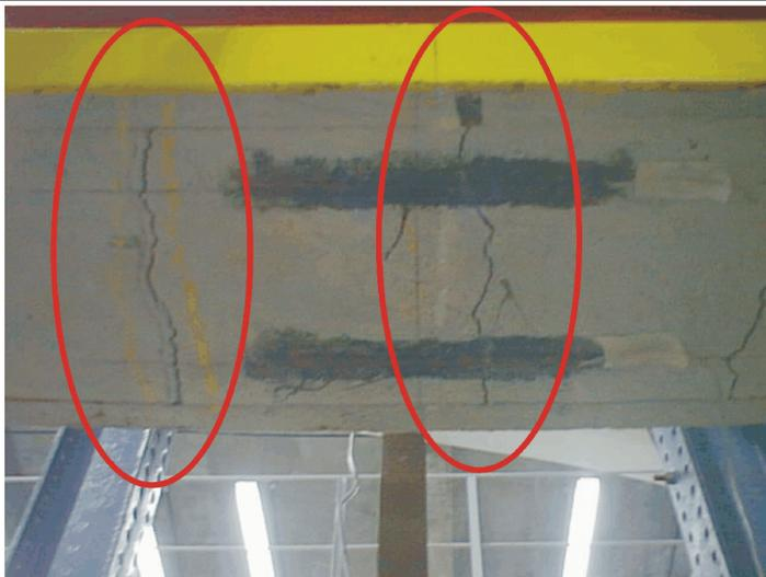
Figura 4.20 – Detalhe da ruptura dos extensômetros – BMN-1
