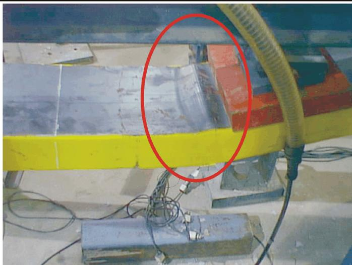
Figura 4.36 – Detalhe da flambagem distorsional da fôrma da laje – BMN-3.
