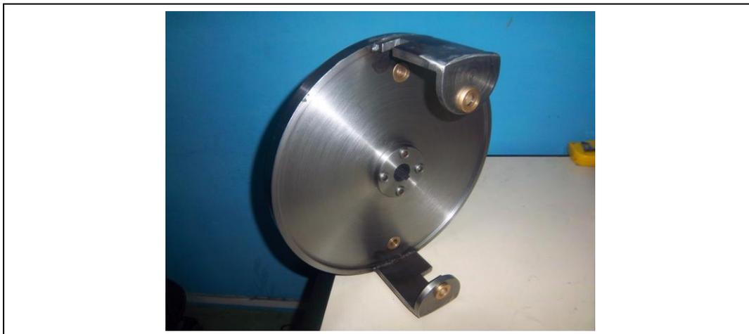
Figura 87 – Volante com as buchas montadas.
