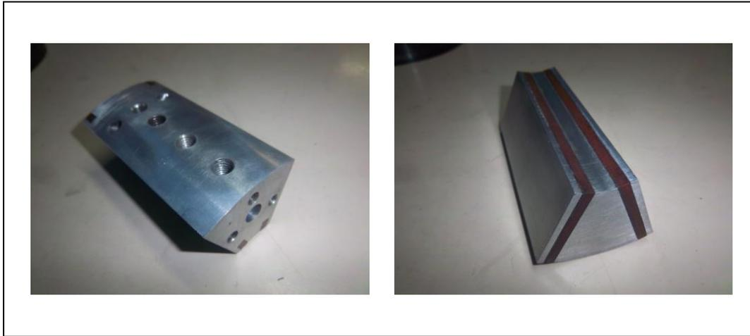
Figura 36 – Deslocador do rotor externo com raspadores fabricados.
