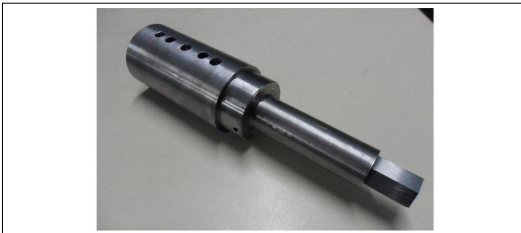
Figura 14 – Rotor interno fabricado.
