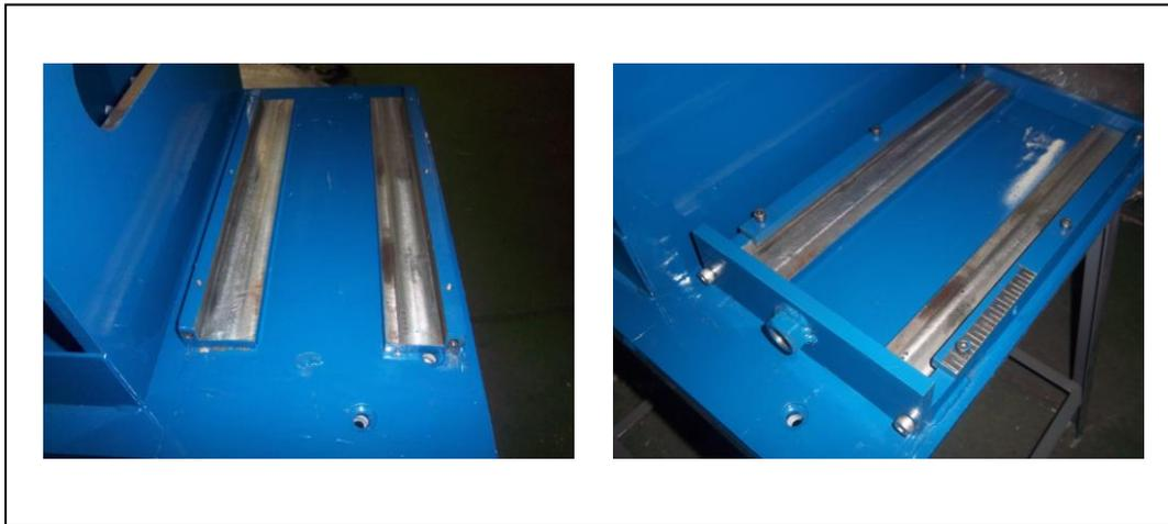
Figura 106 – Guias, batentes e fixadores montados.
