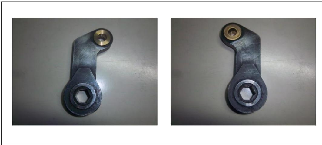
Figura 69 – Braço reto principal do rotor interno com as buchas fabricadas.
