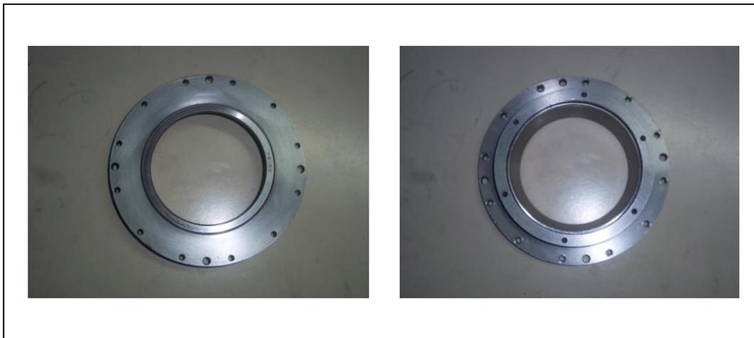
Figura 57 – Peça nº 2 da carcaça dianteira fabricada.
