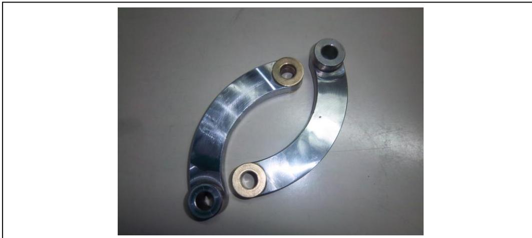
Figura 73 – Braços em curva fabricados.
