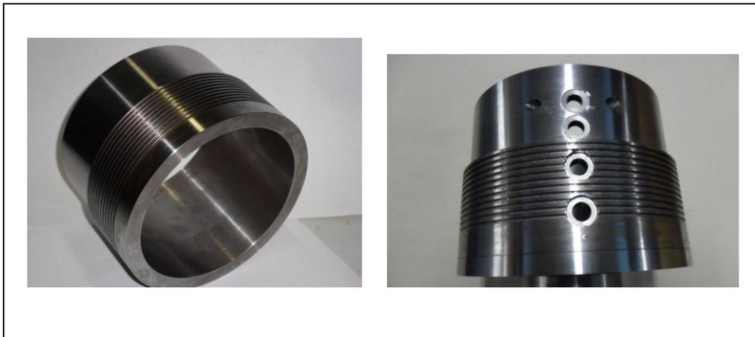
Figura 18 – Corpo do rotor externo, peça bruta e fabricada.
