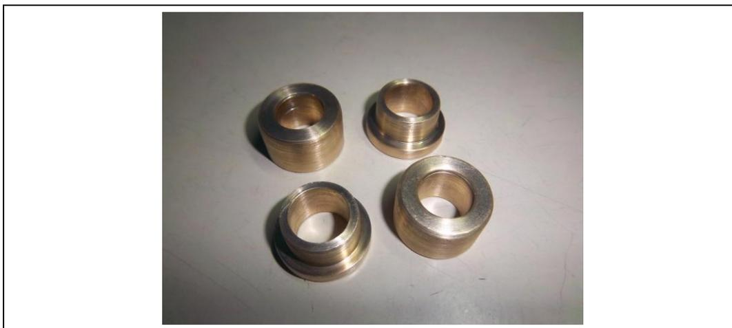
Figura 89 – Buchas do volante fabricadas.
