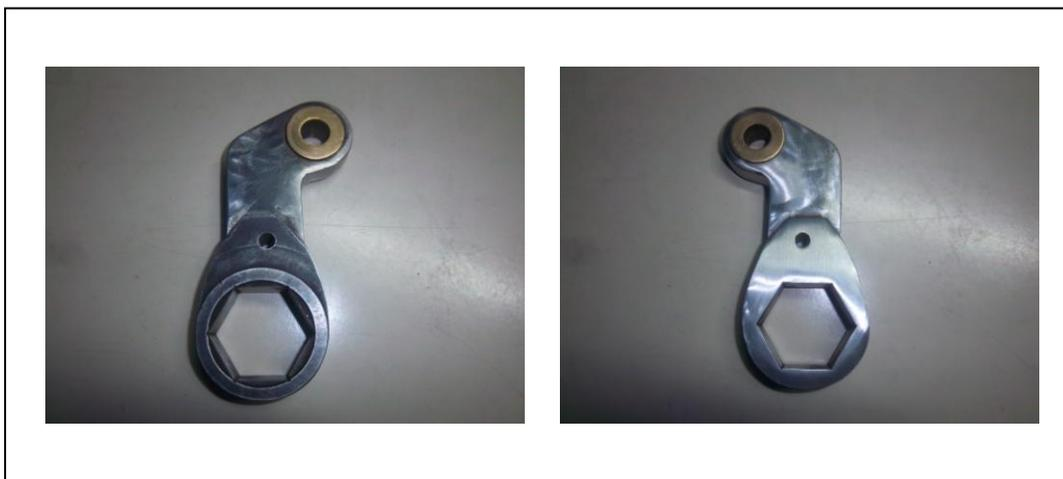
Figura 70 – Braço reto principal do rotor externo com as buchas fabricadas.
