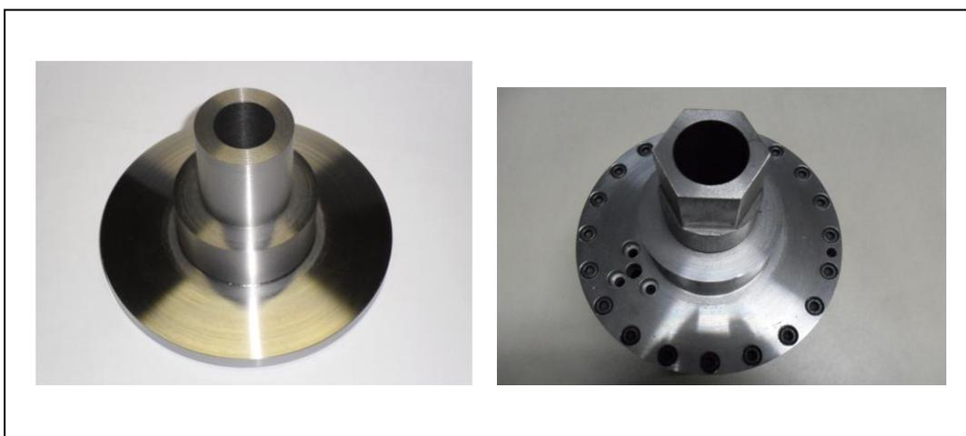
Figura 22 – Frente do rotor externo, peça bruta e fabricada.
