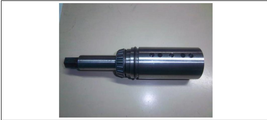
Figura 45 – Rotor interno, bucha e rolamento montados.
