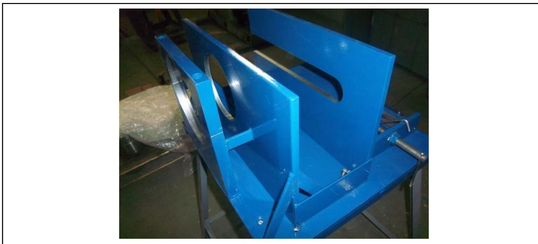
Figura 102 – Espaçadores, barras de amarração, chapa lateral de fechamento da caixa de óleo, e terceira chapa da parte fixa.
