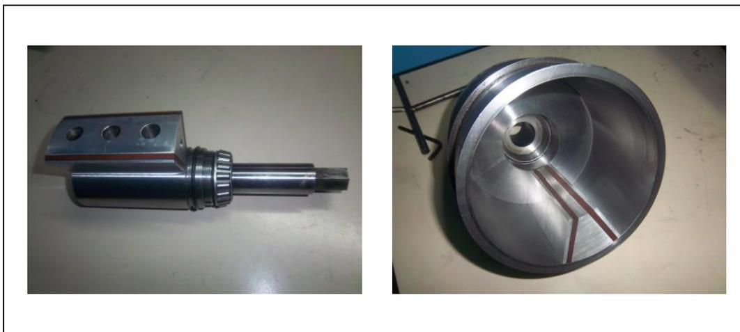
Figura 41 – Rotores retificados, deslocadores e raspadores montados.
