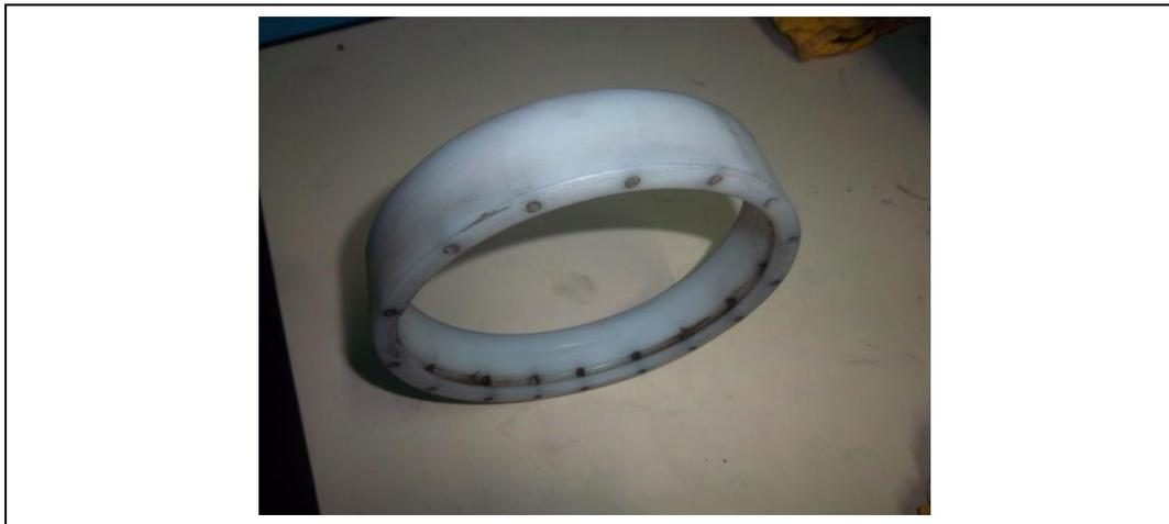
Figura 49 – Bucha do rotor externo fabricada.
