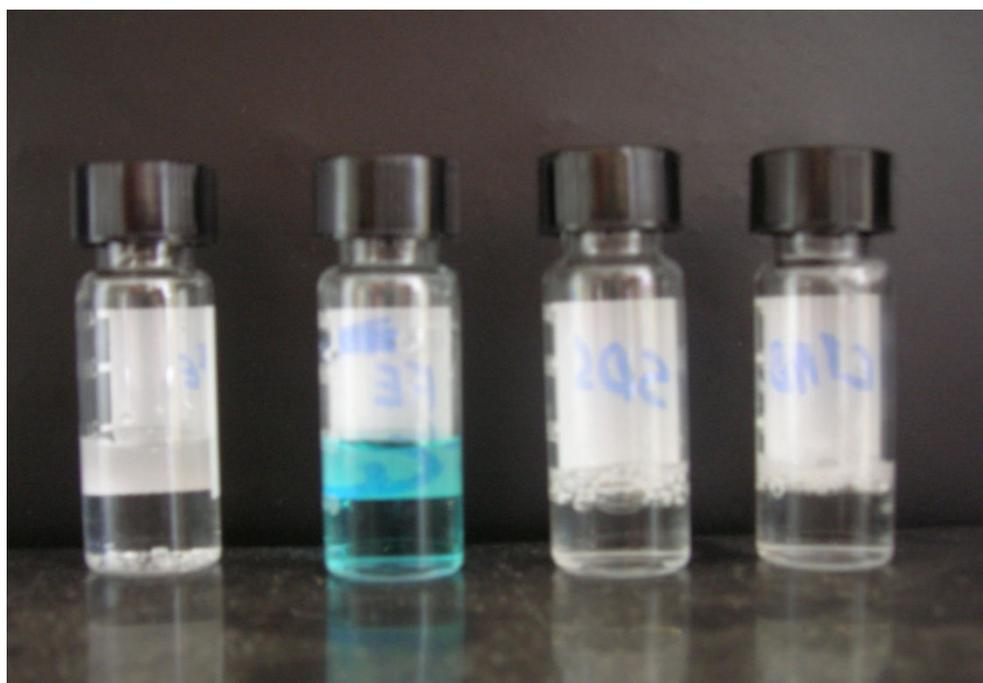
Figura 5.1. Fenantrolina em solução aquosa ( $0,1 \text{ mM}$  em tampão universal pH 7,4) e em presença de  $\text{CuCl}_2$ , SDS e CTAB respectivamente da esquerda para a direita.
