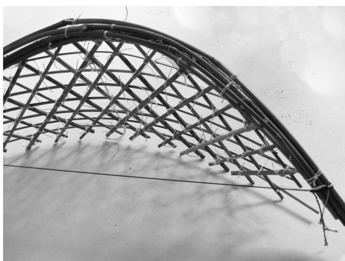
Fig. 55. Modelo de telhado composto por ripas de bambu
