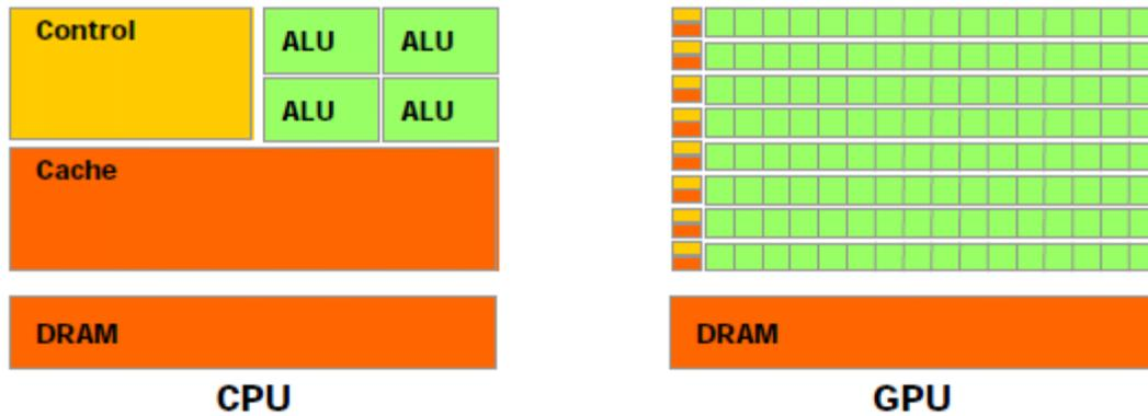
Figura 11 – Diferença entre GPU e CPU com relação à utilização de transistores (NVIDIA, 2009).
