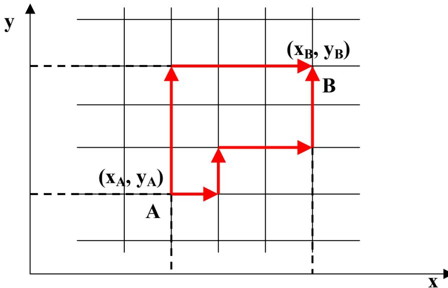
**Figura 02 - Distância Retangular entre os pontos A e B**
