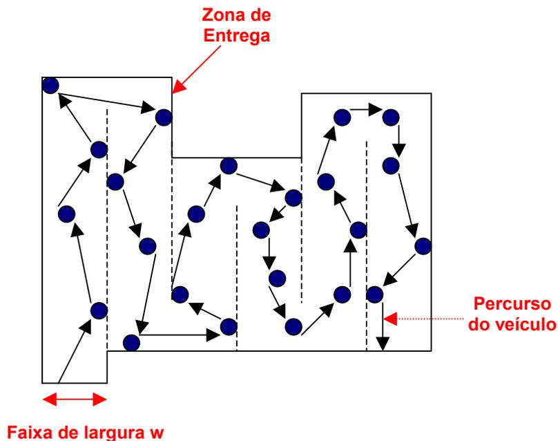
Figura 03 - Roteamento de veículo ao longo de faixas de largura  $w$
