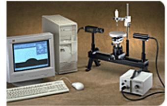
Figura 3.5. – Goniômetro automatizado
