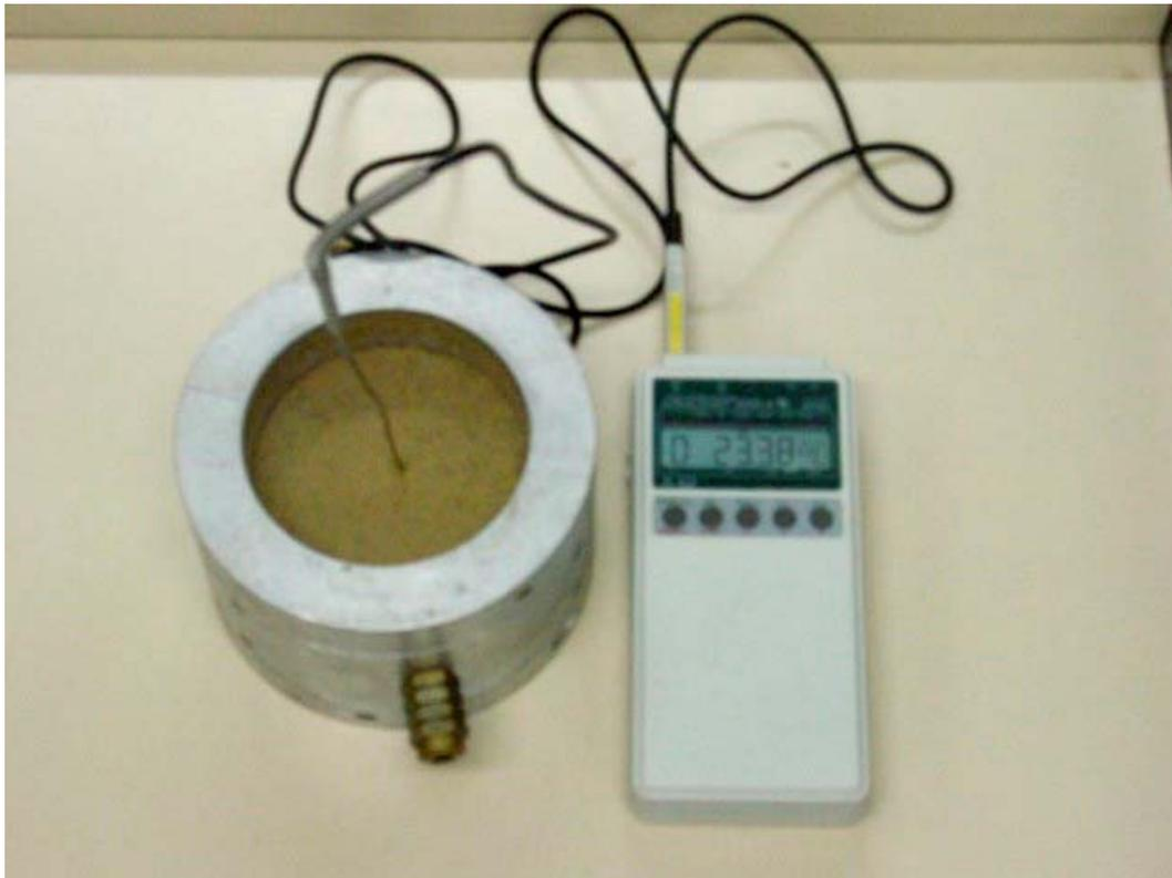
Figura 22- Sonda térmica e *Data-Logger*
