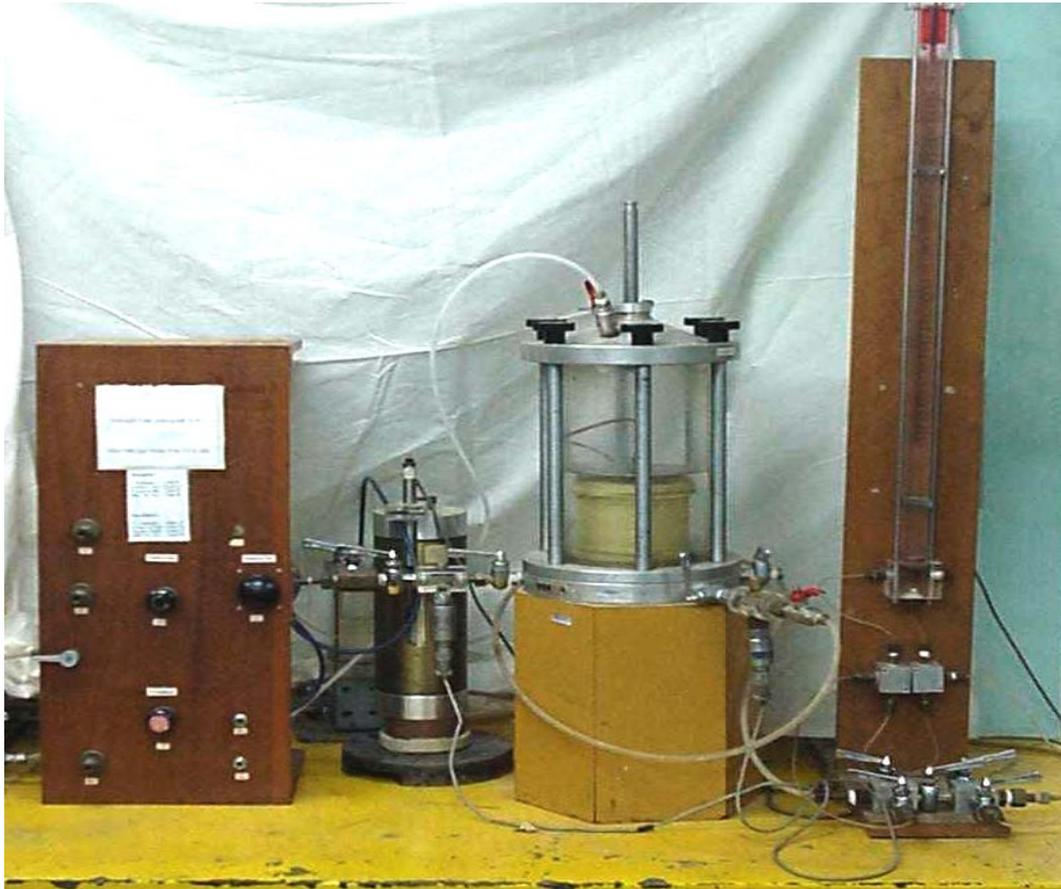
Figura 19 – Permeâmetro desenvolvido no laboratório de Geotecnia da PUC-Rio
