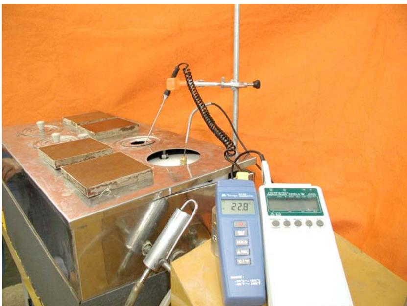
Figura 24 – Medição do calor específico
