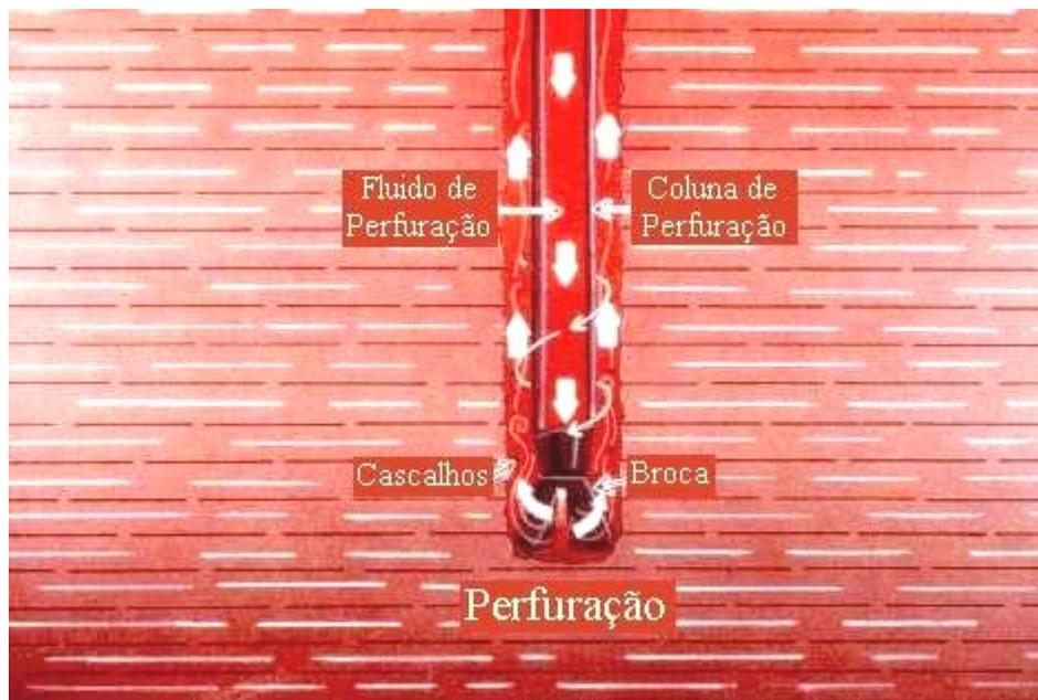
Figura 2.8 – Fluido de perfuração carreando os cascalhos para a superfície
