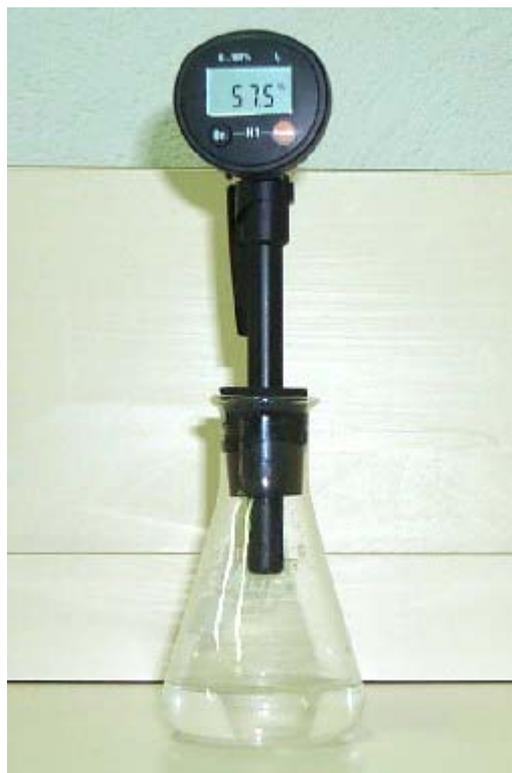
Figura 2. 3 – Termohigrômetro utilizado para medir atividade química e temperatura (Muniz, 2003)
