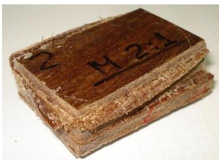
**Amostra 2 (Material 2)** – Resistência à compressão de 25,7 MPa. Inicialmente houve uma flambagem seguida por ruptura que ocasionou o deslocamento das placas de material colado.
