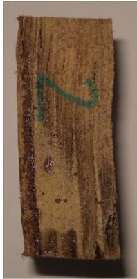
**Amostra 2 (Material 2)** - Resistência à compressão de 9,1 MPa. Tipo de falha: Flambagem do tipo elástica, ou seja, do tipo A (Figura 88), porém com muito menos danos que a encontrada nos Materiais 1 e 3.
