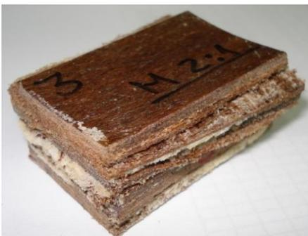
**Amostra 3 (Material 2)** – Resistência à compressão de 28,7 MPa. Inicialmente houve uma flambagem seguida por ruptura que ocasionou o deslocamento das placas de material colado.
