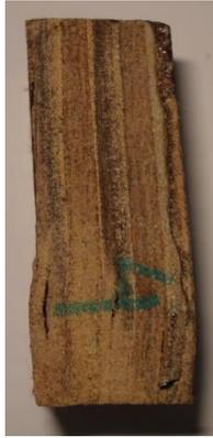
**Amostra 4 (Material 2)** - Resistência à compressão de 10,3 MPa. Tipo de falha: Flambagem do tipo elástica, ou seja, do tipo A (Figura 88), porém com muito menos danos que a encontrada nos Materiais 1 e 3.
