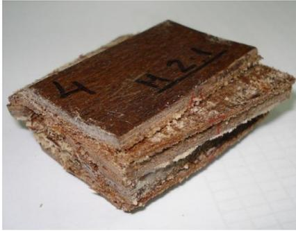
**Amostra 4 (Material 2)** – Resistência à compressão de 24,4 MPa. Inicialmente houve uma flambagem seguida por ruptura que ocasionou o deslocamento das placas de material colado.
