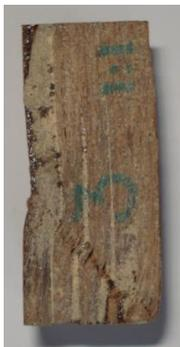
**Amostra 3 (Material 1)** - Resistência à compressão de 28,8 MPa. Tipo de falha: Flambagem com micro trincas devido à rigidez da matriz, ou seja, falhas do tipo D, flambagem e delaminação (Figura 89). Planos de cisalhamento em torno de 45° em relação ao eixo de carregamento.
