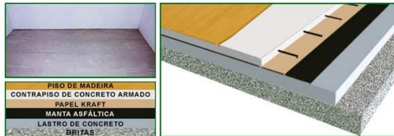
**Figura 136 – Etapas para a instalação do piso de madeira – contrapiso (MADIPÊ).**
