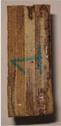
**Amostra 1 (Material 2)** - Resistência à compressão de 6,4 MPa. Tipo de falha: Flambagem do tipo elástica, ou seja, do tipo A (Figura 88), porém com muito menos danos que a encontrada nos Materiais 1 e 3.
