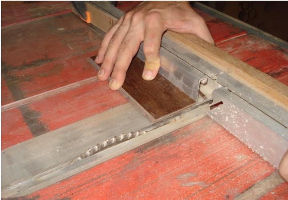
**Figura 147 – Corte das placas de compósito na serra de disco**
