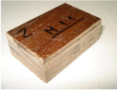
**Amostra 2 (Material 1)** - Resistência à compressão de 63,6 MPa. Não houve flambagem nem ruptura, mas sim, uma diminuição na espessura de aproximadamente 3 mm. O ensaio foi terminado quando o corpo de prova apresentou resistência superior à capacidade máxima da máquina.
