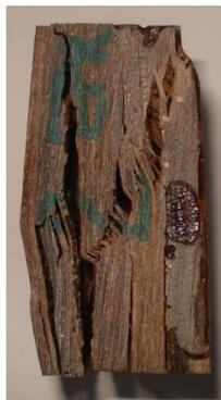
**Amostra 2 (Material 3)** - Resistência à compressão de 45,8 MPa. Tipo de falha: Flambagem com trincas e severas delaminações devido à rigidez da matriz. Falha do tipo D, flambagem e delaminação (Figura 89). Planos de cisalhamento em torno de 45° em relação ao eixo de carregamento.
