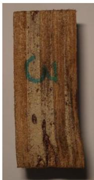
**Amostra 3 (Material 2)** - Resistência à compressão de 6,9 MPa. Tipo de falha: Flambagem do tipo elástica, ou seja, do tipo A (Figura 88), porém com muito menos danos que a encontrada nos Materiais 1 e 3.
