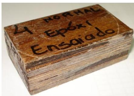
Amostra 4 (Material 3) – Resistência à compressão de 66,9 MPa. Não houve flambagem nem ruptura, mas sim, uma diminuição na espessura de aproximadamente 3,3 mm. O ensaio foi terminado quando o corpo de prova apresentou resistência superior à capacidade máxima da máquina.
