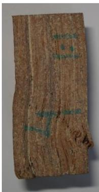
**Amostra 4 (Material 1)** - Resistência à compressão de 27,9 MPa. Tipo de falha: Flambagem com micro trincas devido à rigidez da matriz, ou seja, falhas do tipo D, flambagem e delaminação (Figura 89). Planos de cisalhamento em torno de 45° em relação ao eixo de carregamento.
