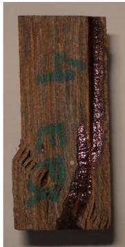
**Amostra 4 (Material 3)** - Resistência à compressão de 47,7 MPa. Tipo de falha: Flambagem com trincas devido à rigidez da matriz. Falha do tipo D, flambagem e delaminação (Figura 89). Plano de cisalhamento em torno de 45° em relação ao eixo de carregamento.
