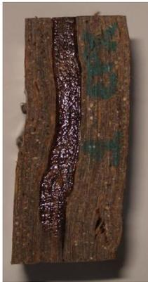
**Amostra 1 (Material 3)** - Resistência à compressão de 50,9 MPa. Tipo de falha: Flambagem com micro trincas devido à rigidez da matriz, falha do tipo D, flambagem e delaminação (Figura 89).
