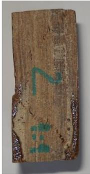
**Amostra 2 (Material 1)** – Resistência à compressão de 30,2 MPa. Tipo de falha: Flambagem com micro trincas devido à rigidez da matriz, ou seja, falhas do tipo D, flambagem e delaminação (Figura 89). Planos de cisalhamento em torno de 45° em relação ao eixo de carregamento.
