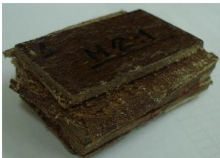
**Amostra 1 (Material 2)** – Resistência à compressão de 30 MPa. Inicialmente houve uma flambagem seguida por ruptura que ocasionou o deslocamento das placas de material colado.
