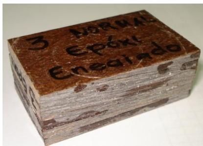
Amostra 3 (Material 3) – Resistência à compressão de 66 MPa. Não houve flambagem nem ruptura, mas sim, uma diminuição na espessura de aproximadamente 3,5 mm. O ensaio foi terminado quando o corpo de prova apresentou resistência superior à capacidade máxima da máquina.
