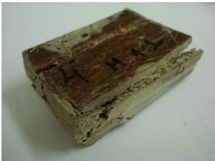
**Amostra 4 (Material 1)** - Resistência à compressão de 52,7 MPa. Com o carregamento houve ruptura. Inicialmente houve uma flambagem seguida por ruptura que formou um ângulo de 45° em relação à superfície de carregamento.
