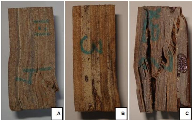
**Figura 89 – Falhas características de cada grupo de materiais: (A) Material 1; (B) Material 2; (C) Material 3**
