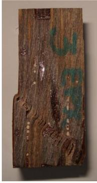
**Amostra 3 (Material 3)** - Resistência à compressão de 50,7 MPa. Tipo de falha: Flambagem com trincas e delaminações devido à rigidez da matriz. Falha do tipo D, flambagem e delaminação (Figura 89). Plano de cisalhamento em torno de 45° em relação ao eixo de carregamento.
