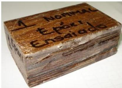
**Amostra 1 (Material 3)** – Resistência à compressão de 63,5 MPa. Não houve flambagem nem ruptura, mas sim, uma diminuição na espessura de aproximadamente 3 mm. O ensaio foi terminado quando o corpo de prova apresentou resistência superior à capacidade máxima da máquina.
