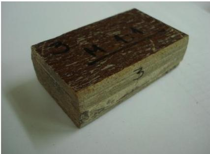
**Amostra 3 (Material 1)** - Resistência à compressão de 65,7 MPa. Houve uma ligeira flambagem, mas sem ruptura. Houve diminuição na espessura de aproximadamente 3,5 mm. O ensaio foi terminado quando o corpo de prova apresentou resistência superior à capacidade máxima da máquina.
