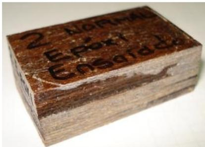
**Amostra 2 (Material 3)** – Resistência à compressão de 65,6 MPa. Não houve flambagem nem ruptura, mas sim, uma diminuição na espessura de aproximadamente 3 mm. O ensaio foi terminado quando o corpo de prova apresentou resistência superior à capacidade máxima da máquina.
